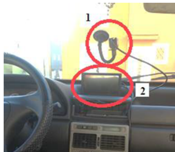
Figura 4. Sistema de detección de señales de tránsito del Ecuador, en los casos Pare, Ceda el paso y Velocidad (50 y 100), instalado sobre el parabrisas de un vehículo experimental.
