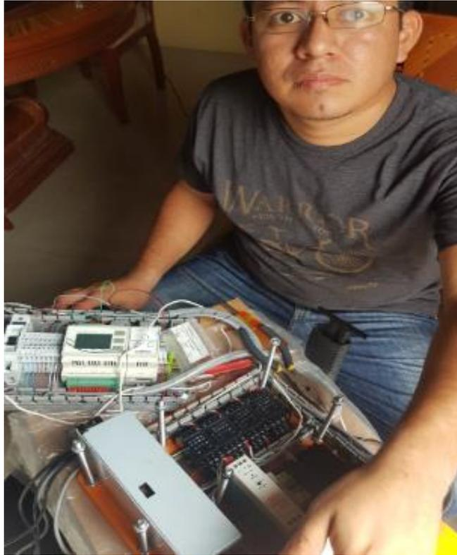
*Figura 127: Conexión de relés (Autores, 2018)*
