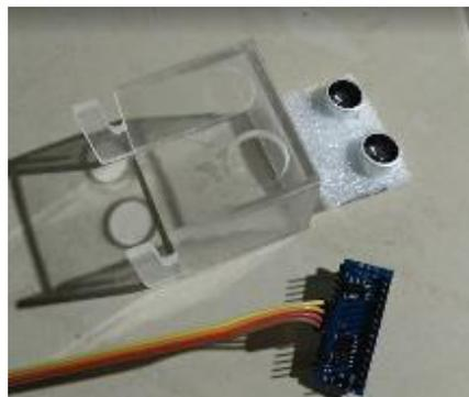
*Figura 92: Porta-sensor para Sensor nivel (Autores, 2018)*
