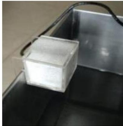
*Figura 94: Ubicación del sensor de nivel en tanque 3 (Autores, 2018)*
