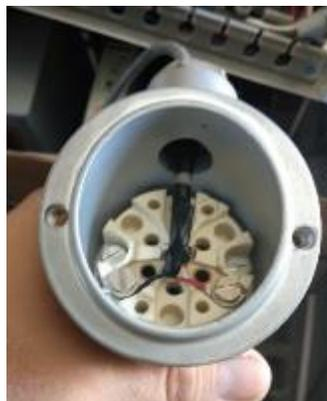
Figura 116: Conexión pastilla termopozo (Autores, 2018)
