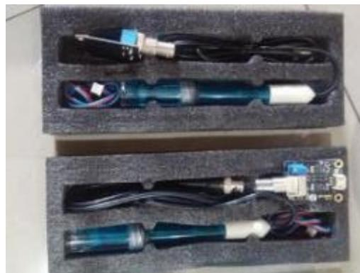
*Figura 78: Sensores de pH y transductores (Autores, 2018)*
