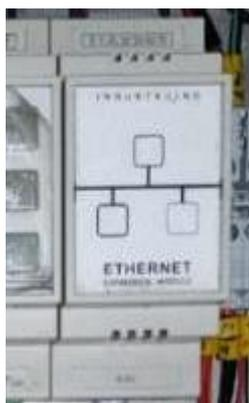
Figura 73: Modulo Ethernet (Autores, 2018)
