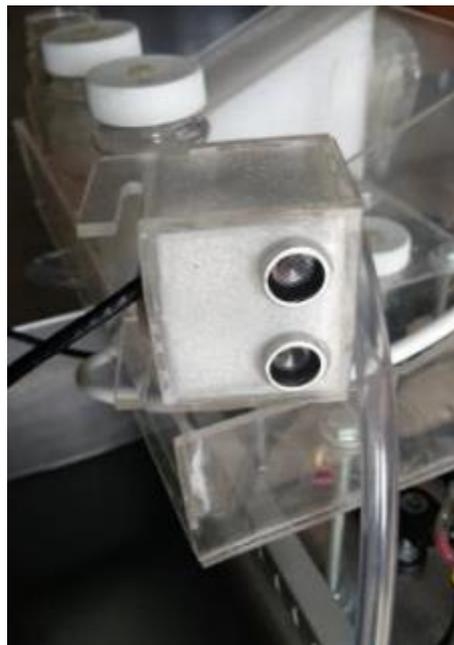
*Figura 123: Soporte de sensor de nivel (Autores, 2018)*
