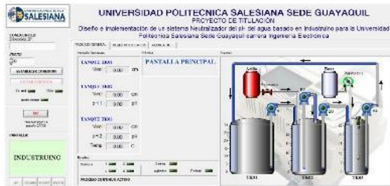
Ilustración 4 Pantalla general Scada LabVIEW
