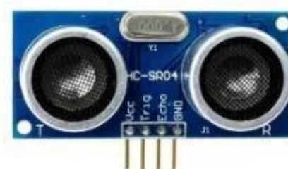
Figura 10: Sensor de nivel ultrasónico HC-SR04 (Autores, 2018)
