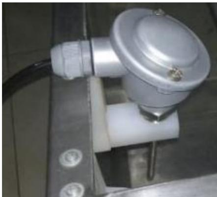
*Figura 102: Adaptador-soporte para PT100 en tanque reactor (Autores, 2018)*
