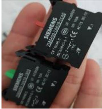
Figura 63: Bloques normalmente cerrado y abierto del interruptor (Autores, 2018)
