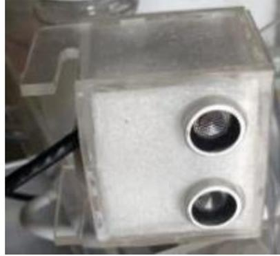
*Figura 93: Caja de protección de acrílico para el sensor de nivel (Autores, 2018)*
