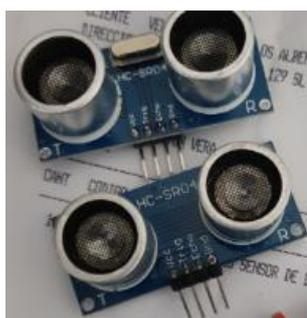
Figura 74: Sensor de nivel ultrasónico HC-SR04 (Autores, 2018)
