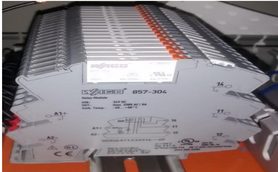
Figura 116. Ubicación de relés WAGO 857-304. (WAGO, DISPOSITIVOS DE ACTIVACION, 2017).
