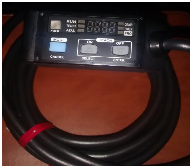
Figura 20. Sensor de marcas digitales PANASONIC LX-101-P. (PANASONIC, 2018)
