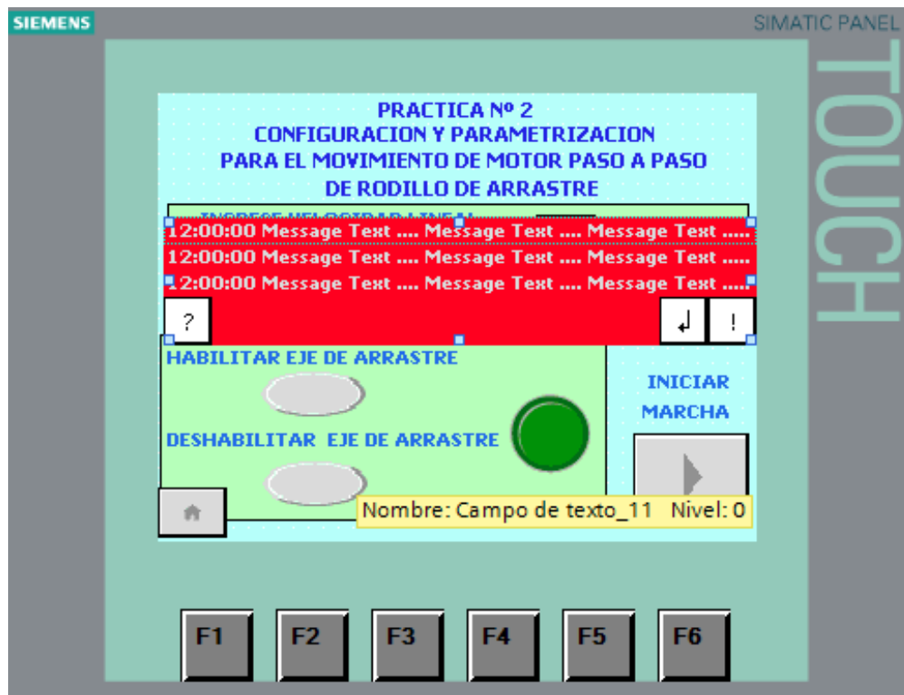
Figura 165. Ventana de avisos de velocidad maxima Rodillo de Arrastre. (Los Autores)
