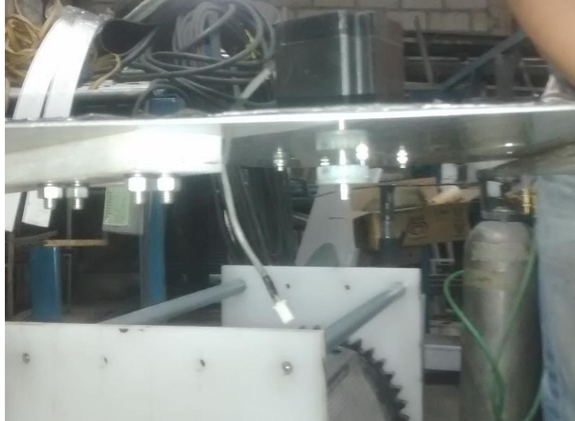
Figura 94. Motor acoplado con polea dentada, en plancha de 3mm. (Los Autores).
