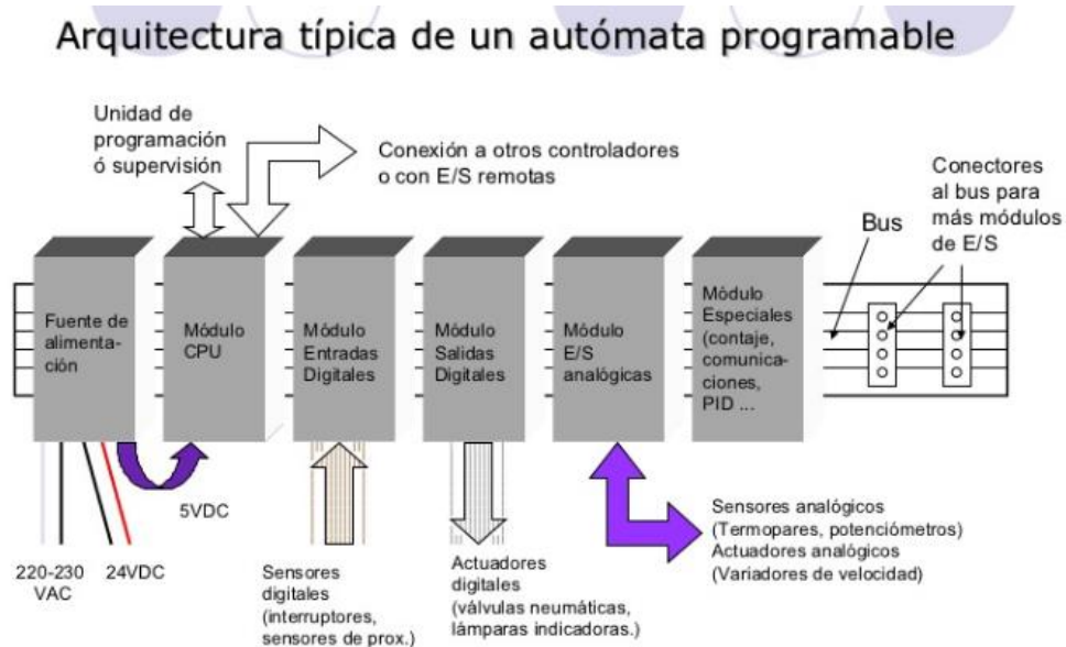
Figura 19. Arquitectura de un autómata programable. (Sobrevilla Gonzalez, 2012)
