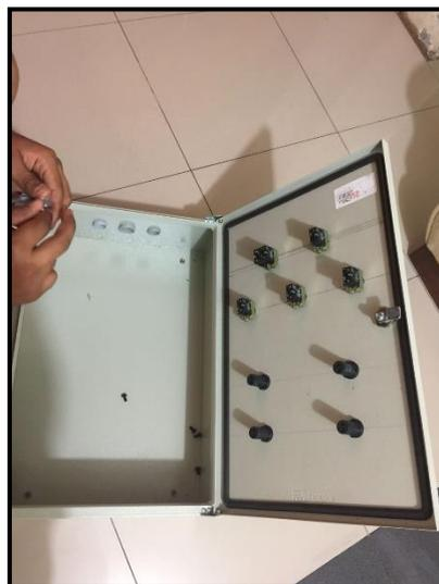
**Figura 68.** Montaje de las luces piloto y botoneras.
