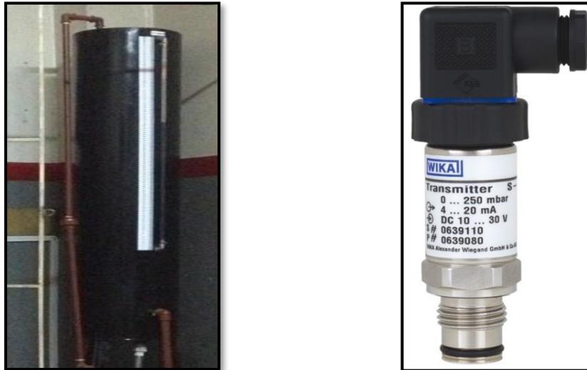
**Figura 57.** Tanque 2 y transmisor de presión.
