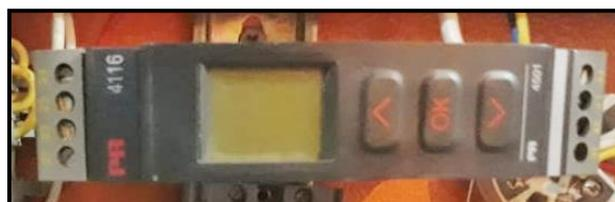
**Figura 49.** Convertidor Universal de señales (PR).
