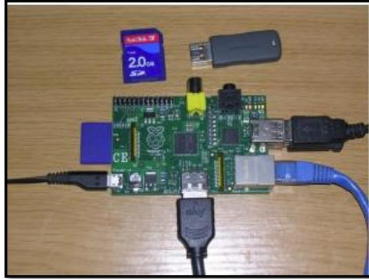
**Figura 23.** Conexiones de Raspberry Pi.
