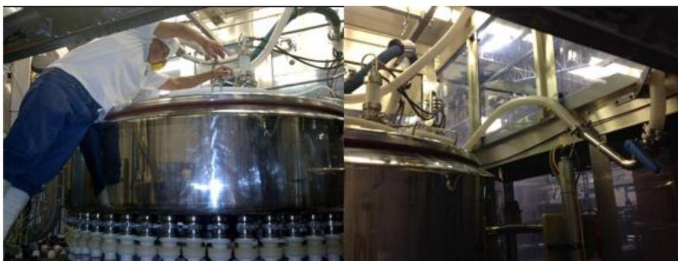
Figura 35. Colocación de válvula y manguera
