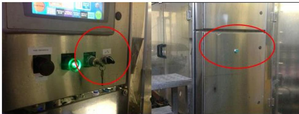
Figura 36. Reubicación de botonera para el proceso de limpieza
