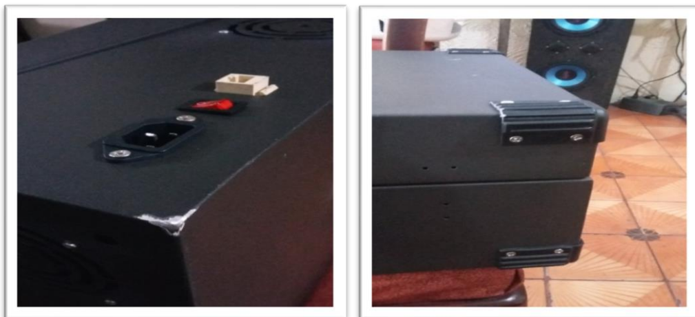
Figura 43: Instalación de esquineros en el maletín
