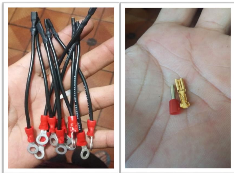
Figura 37: Terminales usados para el cableado
