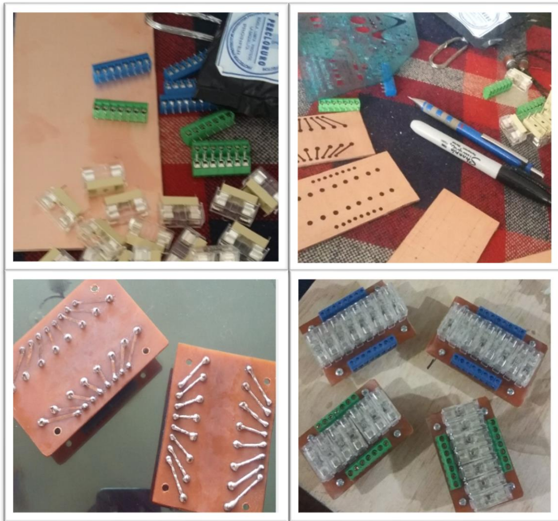
Figura 31: Construcción de los borneros porta fusibles.
