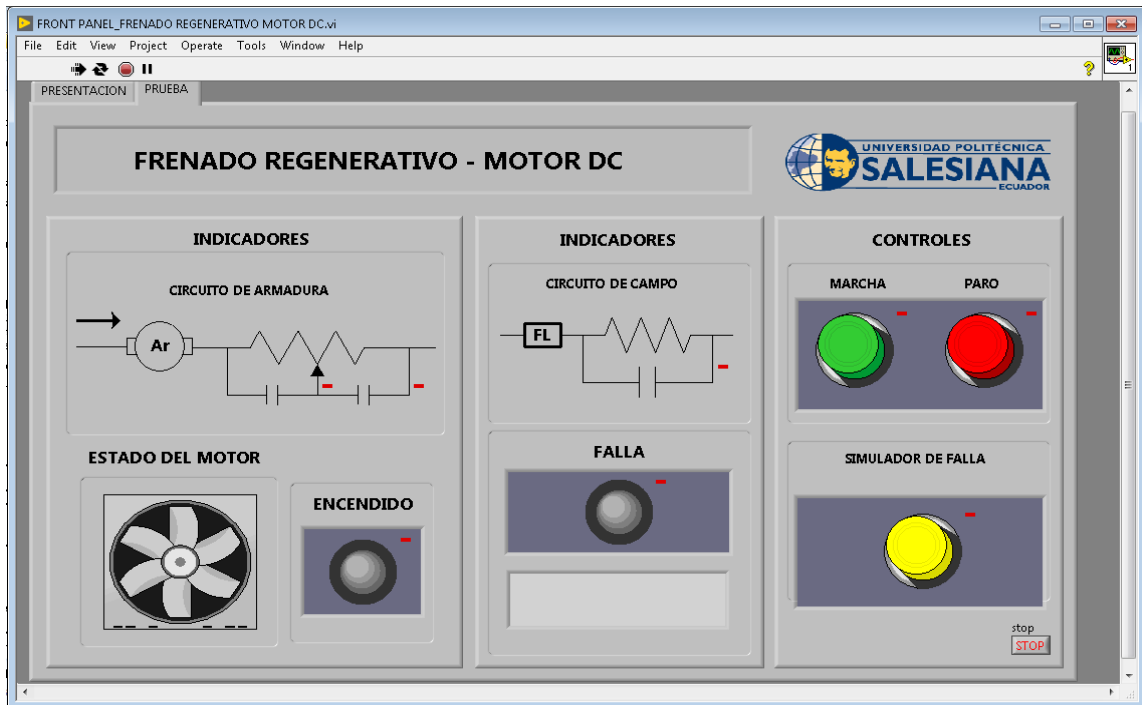
Figura 148: Ventana del Panel Frontal final en LabVIEW.
