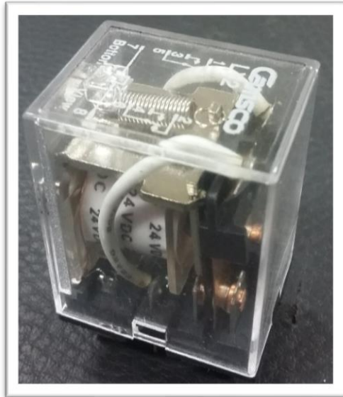
Figura 20: Relé industrial de interfaz de 8 pines
