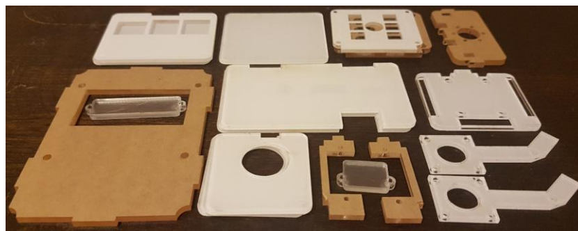
Figura 40 Piezas de acrílico cortadas a laser Fuente: Autor
