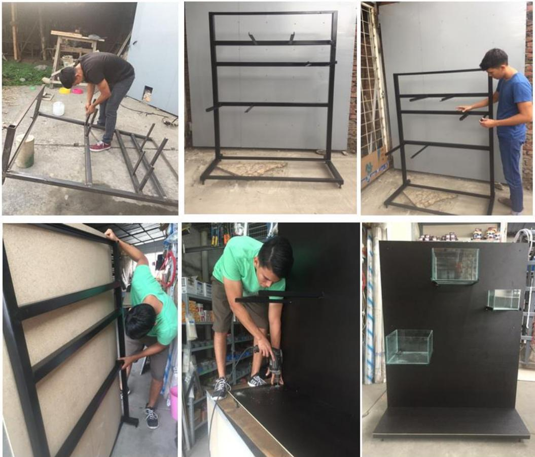
**Figura 39:** Elaboración de la estructura metálica y montaje del tablero.
