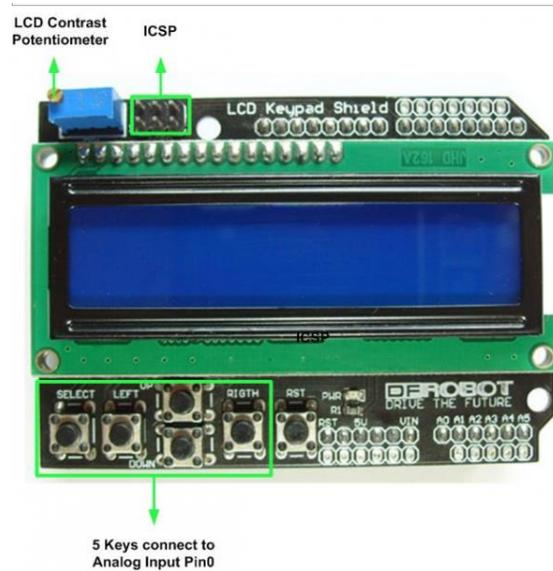
**Figura 28:** LCD Keypad Shield para Arduino.
