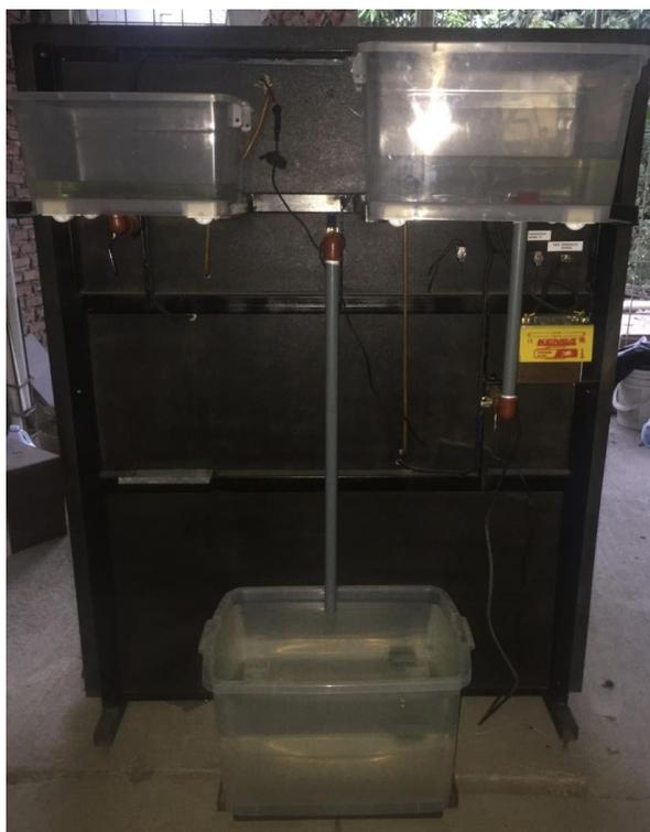
**Figura 44:** Tanques de alimentación y desfogue del sistema.
