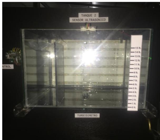
**Figura 42:** Tanque 2 (TQ2), Neutralización.
