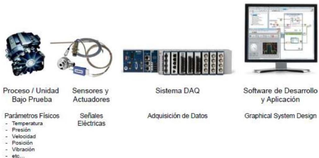
**Figura 9:** Esquema general de adquisición de datos. Ejemplos de equipos/ dispositivos que se usan para el desarrollo del sistema que permite adquirir datos.
