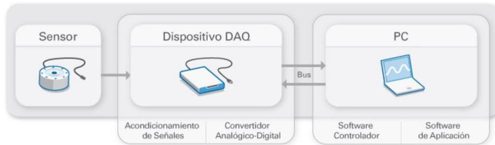
**Figura 10:** Diagrama de conexiones. Se observa en la figura las conexiones básicas de los componentes de un sistema de adquisición de datos.
