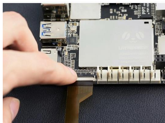
Figura 42: Ajuste del actuador de la ranura de la pantalla IPS. (LattePanda, 2016).
