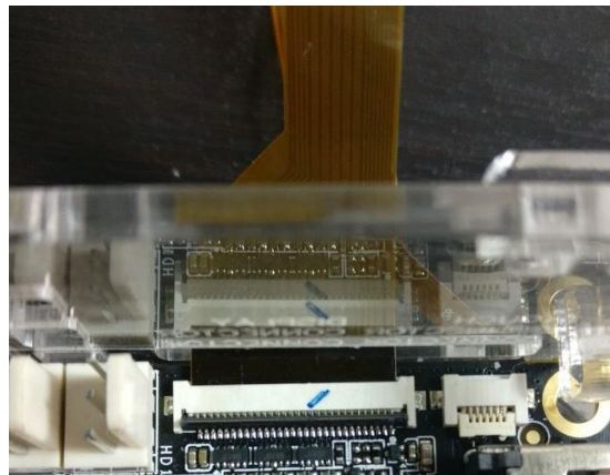
Figura 41: Conexión de cable flexible plano dentro de la ranura para pantalla IPS.
