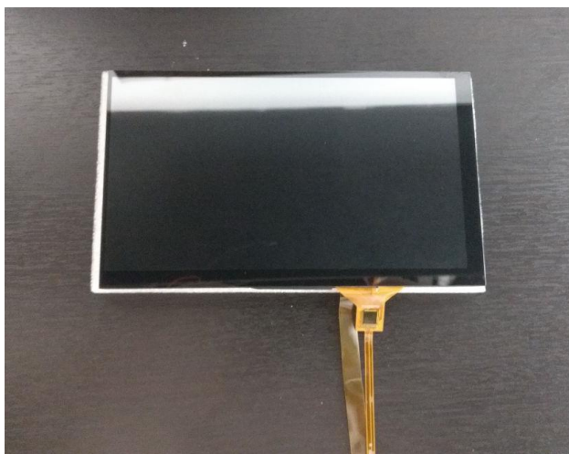
Figura 38: Montaje de pantalla Capacitiva sobre pantalla IPS.
