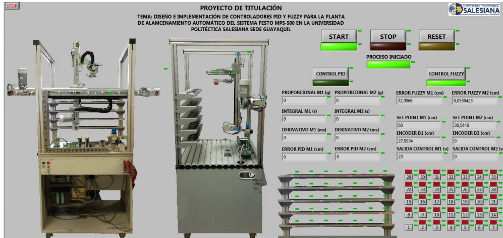
Figura 200. Arranque del motor M1 con el control Fuzzy en el sistema Scada
