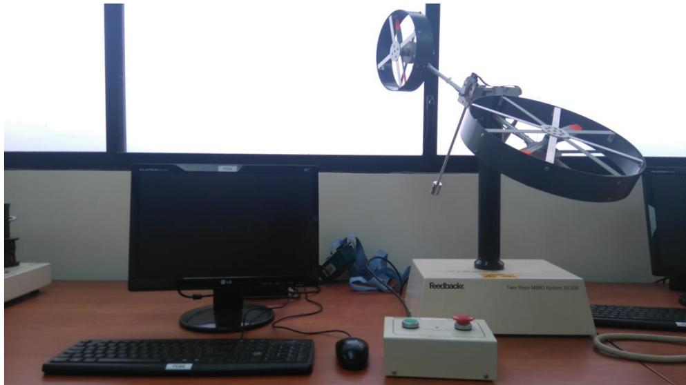
**Figura 1 Módulo de trabajo, a la izquierda el PC # 8 y a la derecha el sistema TRMS**
