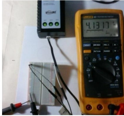
Figura 54: Medida de Voltaje de Salida para una celda.
