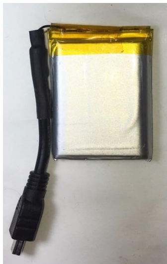
Figura 16: Batería de Litio 3.7V y 2000 mAh
