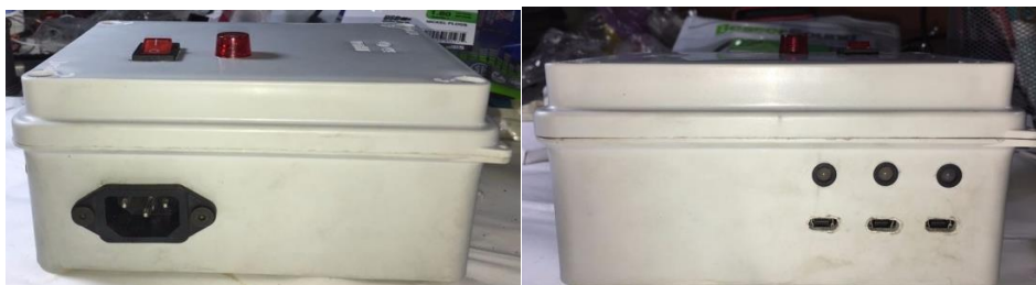
Figura 84: Cargador de baterías de Litio. Fuente: Carlos Daniel Bohórquez González - Hugo Enrique García Hernández
