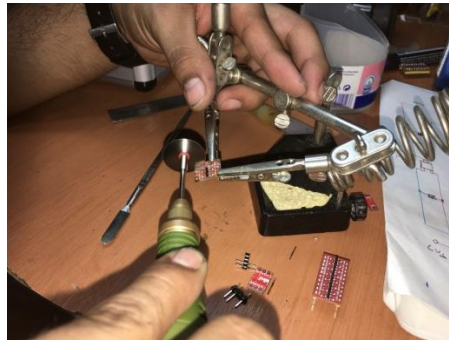
Figura 70: Proceso de reducción del bidireccional.
