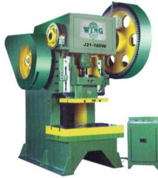
Figura 5. Prensa mecánica excéntrica [9]
