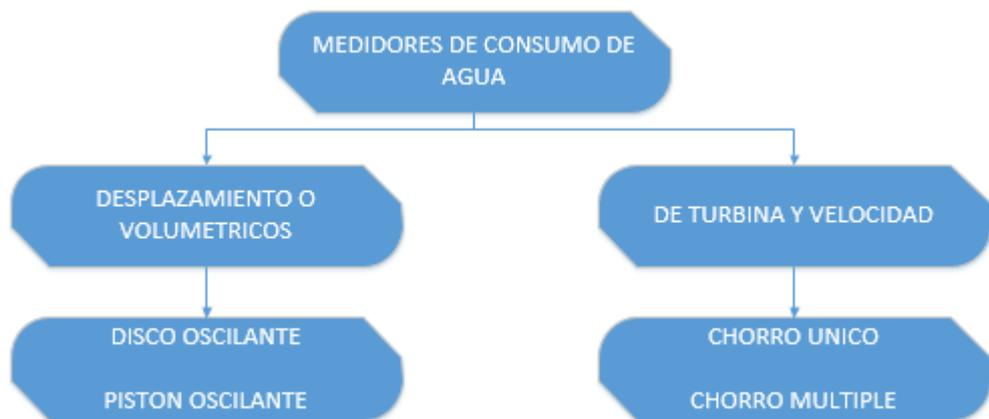
Figura 1.6 Clasificación de los medidores de agua convencionales
