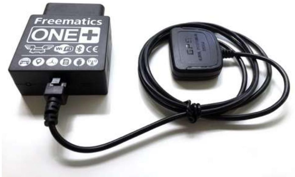
*Figura 10 Freematics con el Modulo GPS (Freematics.com)*
