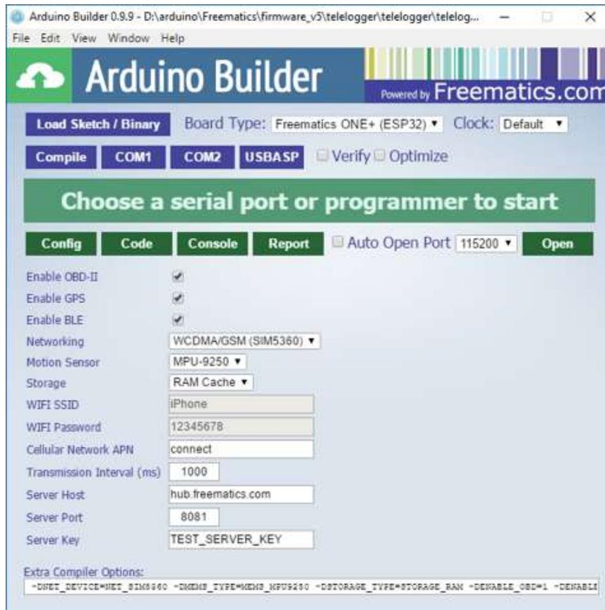
Figura 11 Configuración del Freemetics One + con Arduino Builder (Autor)
