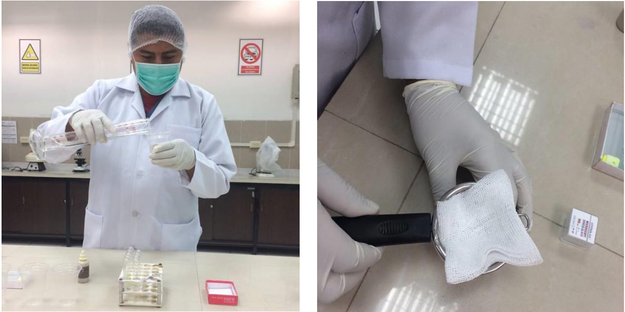
Foto 2. Colocación de solución salina en la muestra y proceso de cernido
