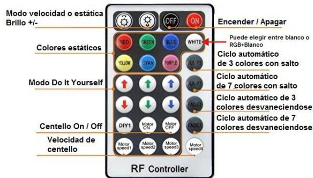
Figura 97: Control de la ducha de fibra óptica
