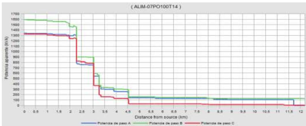
**Figura 4-26.** Perfil en kVA del alimentador Osorio.
