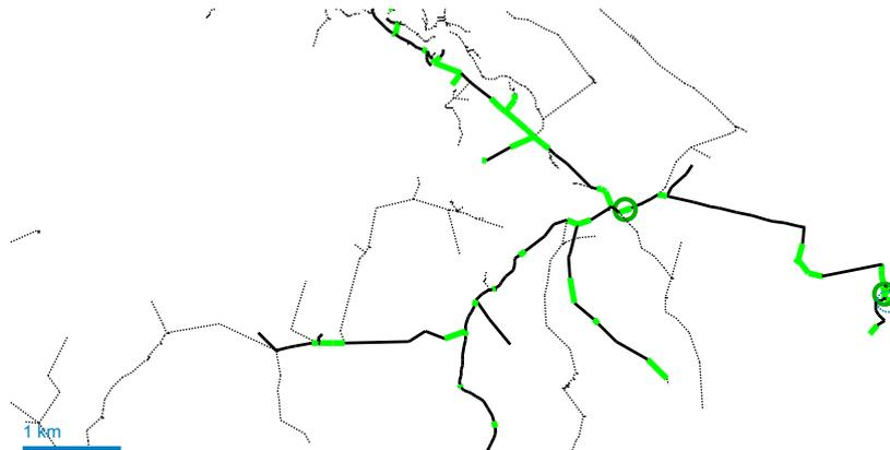
**Figura 5-37.** Ubicación óptima de los dos bancos de RV en el alimentador Piñas.
