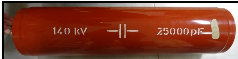
FIGURA 22: CAPACITOR DE IMPULSO HV9112 [32].
