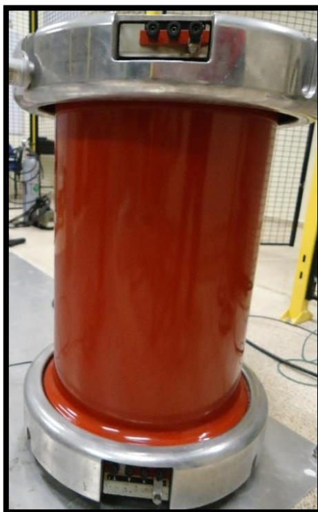
FIGURA 16: TRANSFORMADOR DE PRUEBA HV9105 [32].
