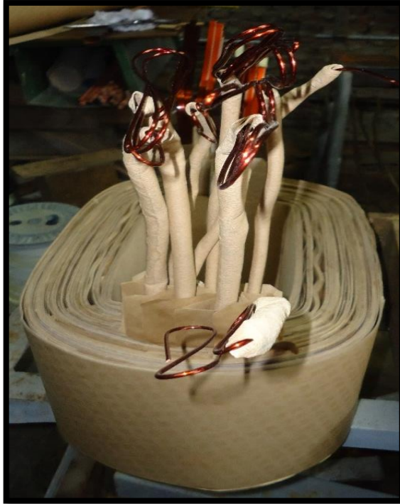
FIGURA D. 6: BOBINA TERMINADA PARA EL PROCESO DE SECADO.
