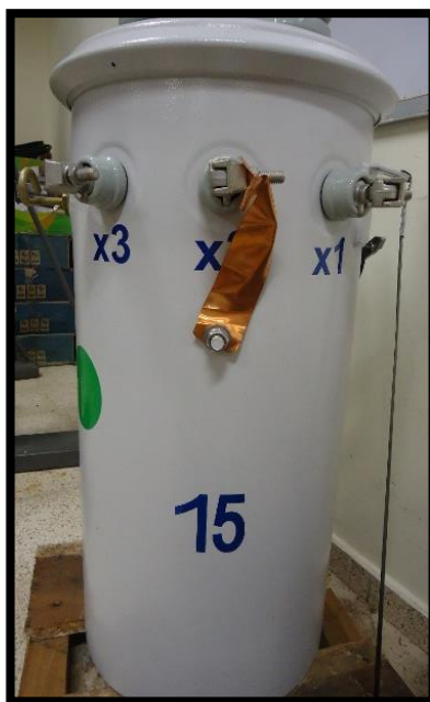
FIGURA 14: TRANSFORMADOR MONOFÁSICO DE DISTRIBUCIÓN 15 KVA [31].
