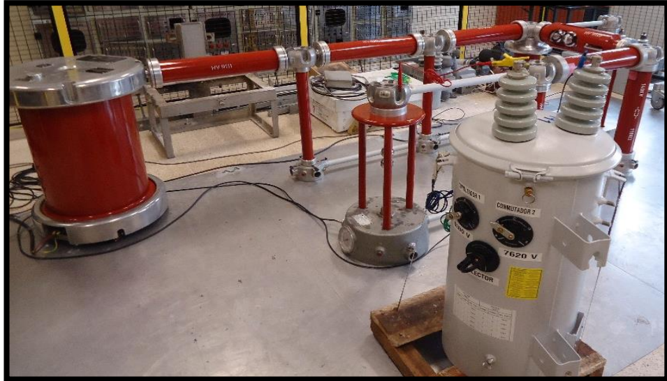
FIGURA 52: TRANSFORMADOR SOMETIDO A PRUEBA DE IMPULSO TIPO MANIOBRA.
