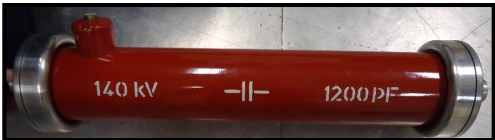
FIGURA 25: CAPACITOR DE CARGA HV9120 [32].
