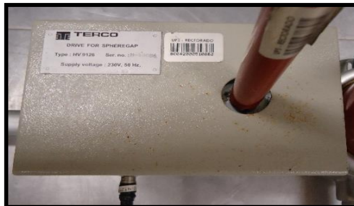
FIGURA 30: TIMONEL DEL ESPINTERÓMETRO HV9126 [32].
