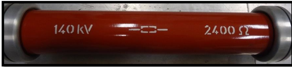
FIGURA 28: RESISTENCIA DE COLA DE ONDA HV9123 [32].
