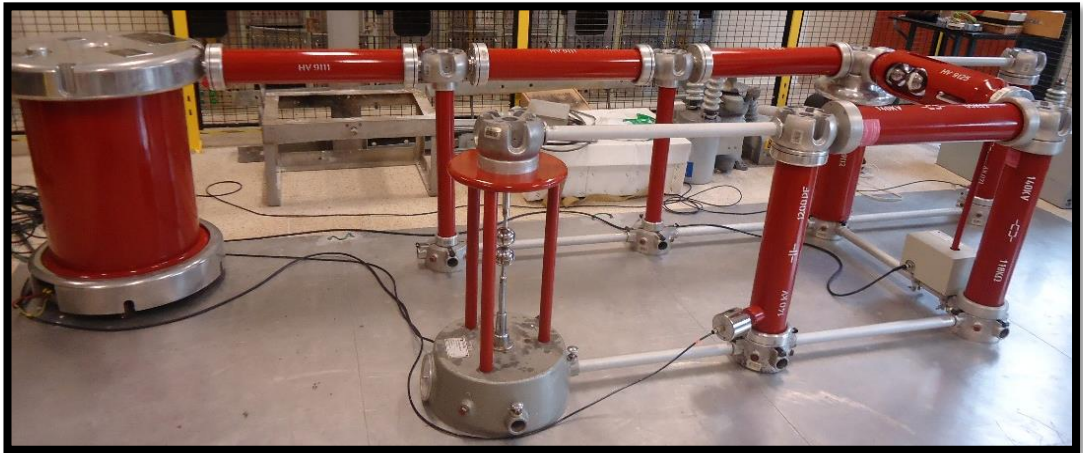
FIGURA 49: CIRCUITO DE IMPULSO TIPO MANIOBRA SIN CARGA.
