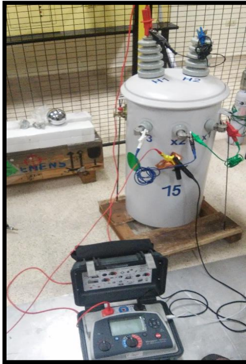
FIGURA 56: CONEXIÓN ALTA TENSIÓN - BAJA TENSIÓN MÁS TIERRA.
