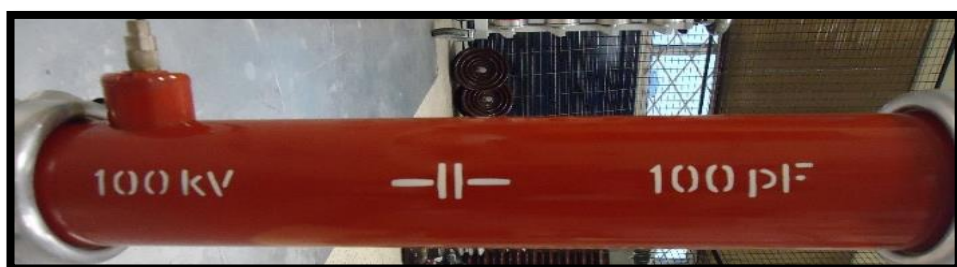
FIGURA 36: CAPACITOR DE MEDICION HV9141 [32].
