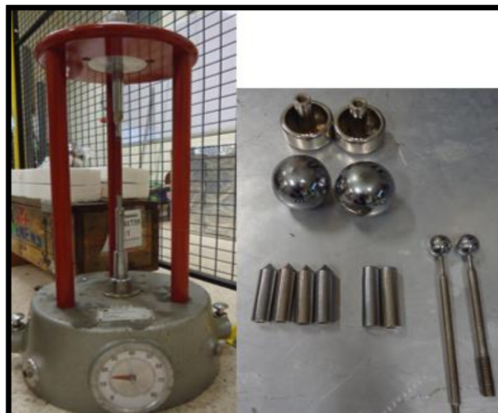
FIGURA 34: ESPINTERÓMETRO PARA MEDICIÓN HV9133 Y ELECTRODOS [32].
