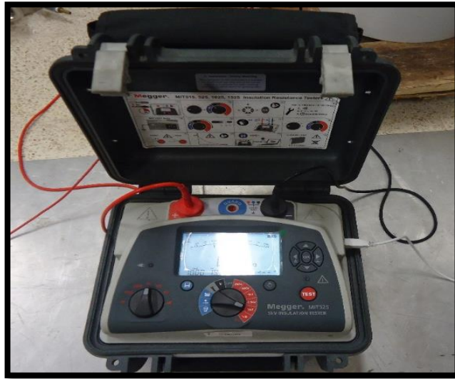
FIGURA 53: MEGÓHMETRO EN SUPERFICIE NIVELADA PARA ATERRIZAR [34].
