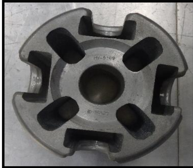
FIGURA 19: COPA CONECTORA DE ALUMINIO HV9109 [32].
