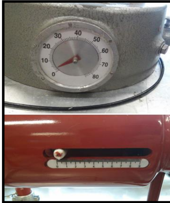
FIGURA 51: CALIBRACIÓN DEL ESPINTERÓMETRO DE MEDICIÓN HV9133 Y DEL ESPINTERÓMETRO DE ESFERAS HV9125 PARA PRUEBA DE IMPULSO TIPO MANIOBRA.
