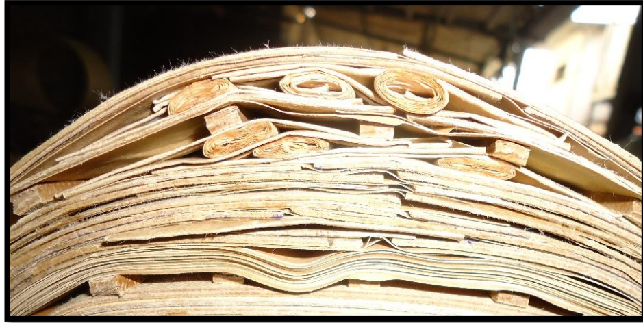
FIGURA D. 2: AISLAMIENTO ENTRE DEVANADOS DE ALTA Y BAJA TENSIÓN Y AISLAMIENTO ENTRE CAPAS.
