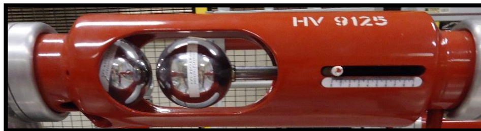
FIGURA 29: ESPINTERÓMETRO DE ESFERAS HV9125 [32].
