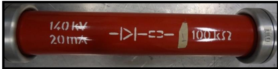
FIGURA 21: RECTIFICADOR DE SILICIO HV9111 [32].
