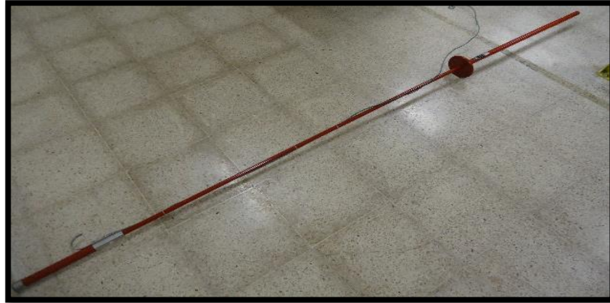
FIGURA 17: BARRA DE DESCARGA HV9107 [32].
