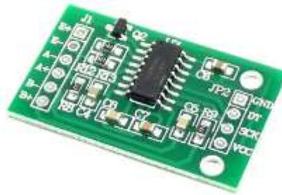
**Figura 2.6** *Modulo transmisor HX711 de celda de carga [25].*
