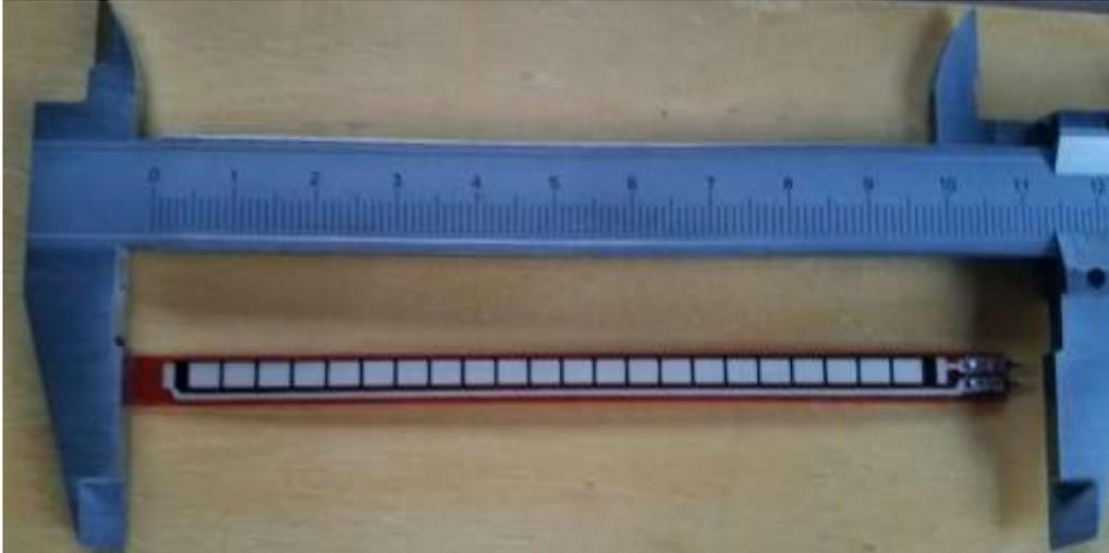
Figura 3.3 Sensor Flex de 4.5 pulgadas
