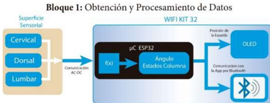
Figura 3.27 Arquitectura de la obtención y procesamiento de datos
