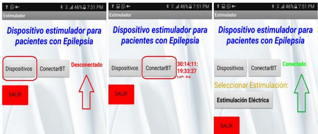
Figura C.4 Conexión inalámbrica de la aplicación mediante Bluetooth
