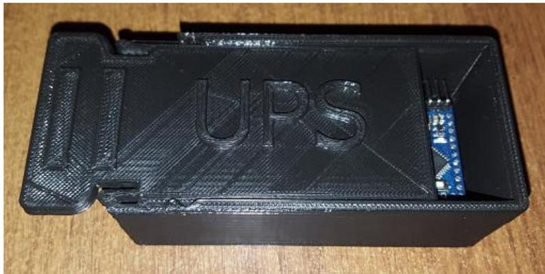
Figura 2.23 *Impresión del modelo físico de la carcasa protectora*
