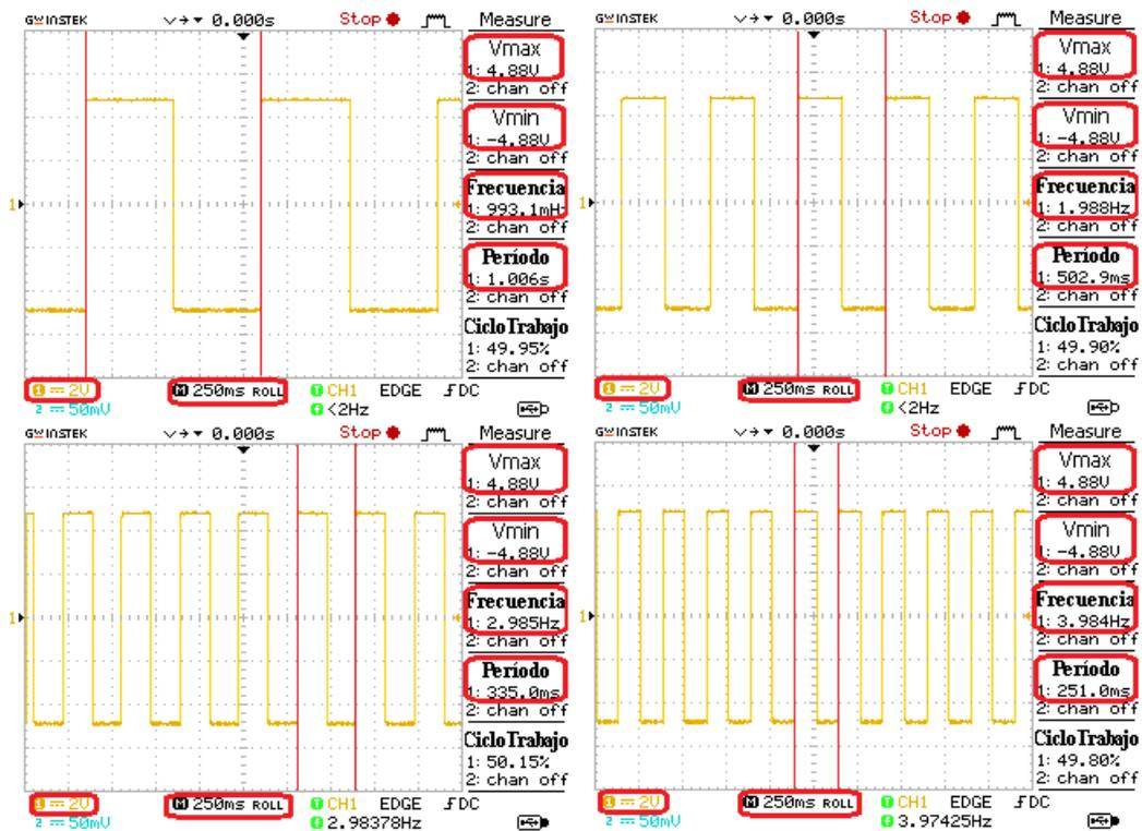
Figura 3.4 Gráficas tomadas del osciloscopio para una estimulación de 1.00 mA a una frecuencia de 1, 2, 3 y 4 Hz
