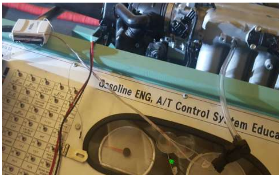
Figura A - 26. Conexión del sensor MAP con la DAQ, en unidad experimental. Fuente: Autores.
