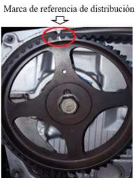
Figura 5.18 Marca de referencia de polea del árbol de levas de admisión alineada para el correcto calado. Fuente: Autores.
