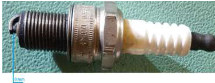
Figura 5.10 Bujía completamente cerrada 0 mm. Fuente: Autores.
