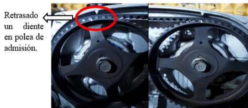
Figura 5.24 Fallo en la polea del árbol de levas de admisión al retrasar un diente (-1). Fuente: Autores.
