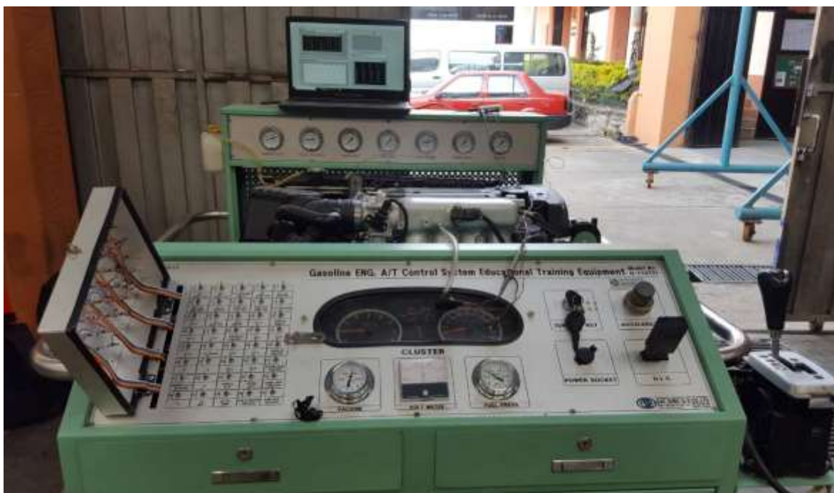
D- 2. Motor de encendido provocado Hyundai Sonata para comprobación del algoritmo de diagnóstico. Fuente: Autores.
