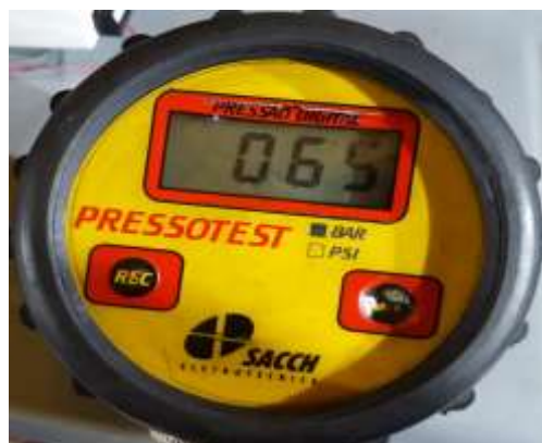
Figura 5.17 Falla de alta presión de combustible. Valor de presión 65 psi. Fuente: Autores.
