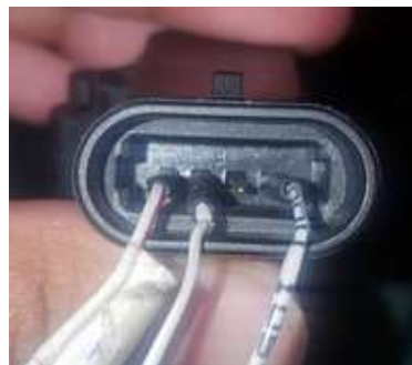
Figura 5.3 Conexión realizada en el sensor MAP para la obtención de datos. Fuente: Autores.
