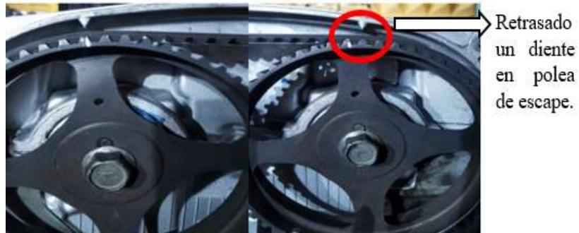
Figura 5.22 Fallo en polea del árbol de levas de escape al retrasar un diente (-1). Fuente: Autores
