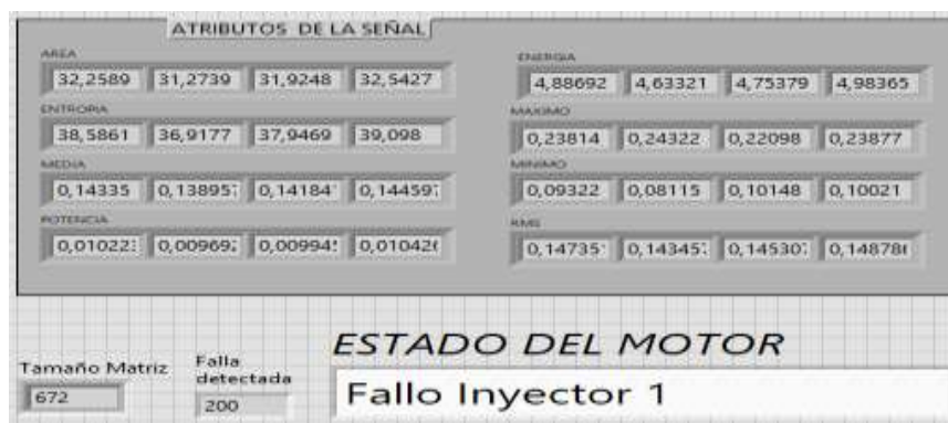
Figura 6.16 Detección de fallo del inyector 1, en motor Hyundai Sonata número 2. Fuente: Autores.
