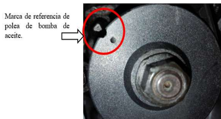
Figura 5.21 Marca de referencia de la polea de la bomba de aceite alineada para el correcto calado. Fuente: Autores.
