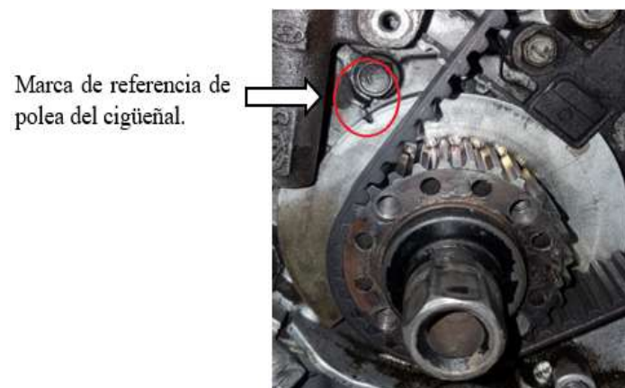
Figura 5.20 Marca de referencia de polea del cigüeñal alineada para el correcto calado. Fuente: Autores.
