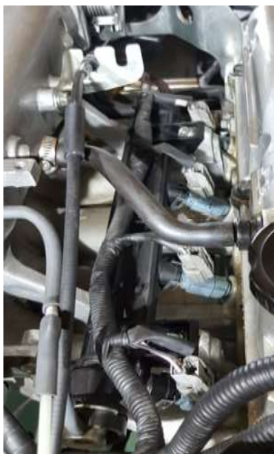
Figura A - 20. Verificación de estado de inyectores. Tiempo de inyección de 2.16 ms, en ralentí. Fuente: Autores.
