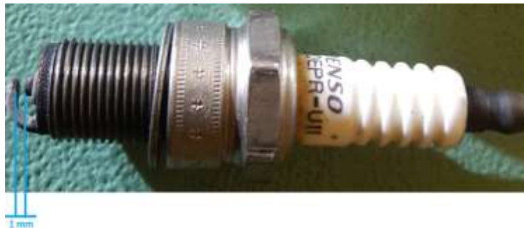
Figura 5.11 Bujía con holgura de 1 mm. Fuente: Autores.
