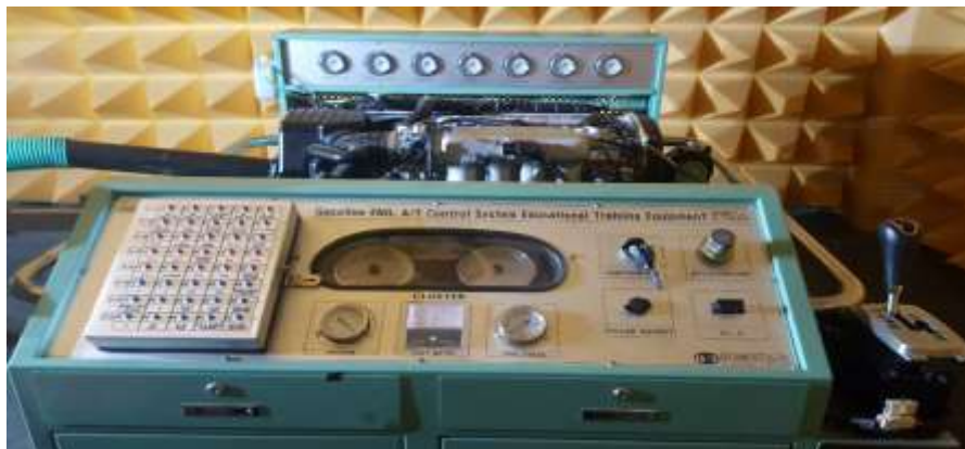
Figura 5.6 Maqueta didáctica para manejo del motor SONATA 2.0. Fuente: Autores.
