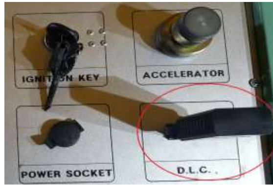
Figura A - 3. Scanner automotriz ELM 327 interface, conectado en la maqueta del motor en experimentación. Fuente: Autores.
