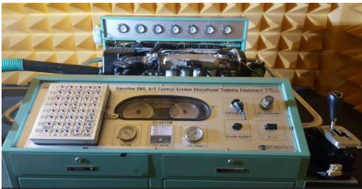
D- 1. Motor de encendido provocado Hyundai Sonata para desarrollo del algoritmo de diagnóstico. Fuente: Autores.
