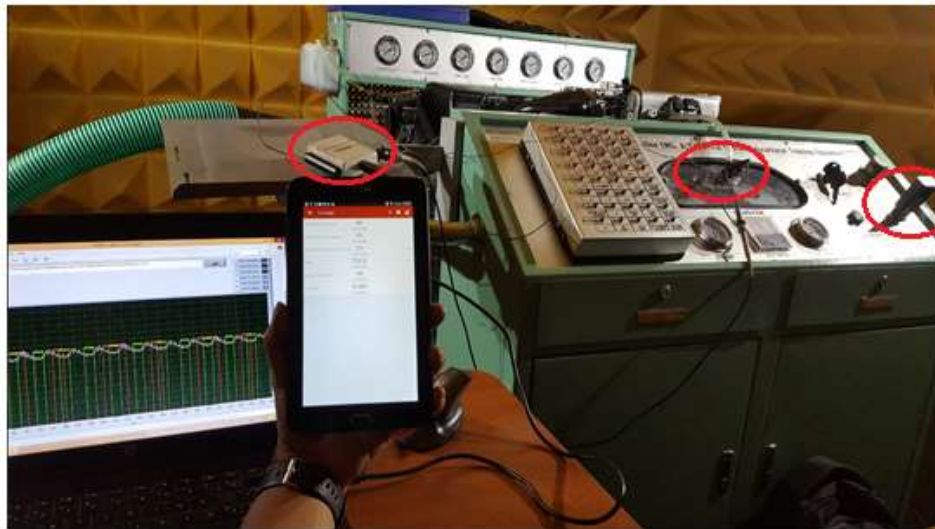
Figura A - 6. Conexiones para la toma de datos reales del motor Hyundai Sonata 2.0. Fuente: Autores.
