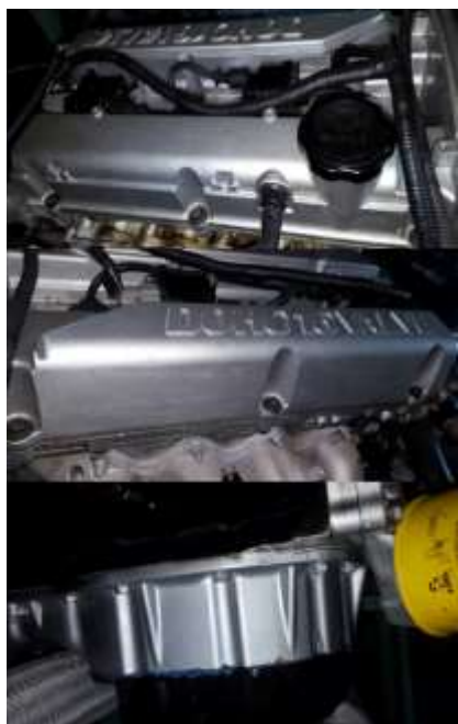
Figura A - 19. Verificación de fugas de aceite en la unidad experimental. Fuente: Autores.
