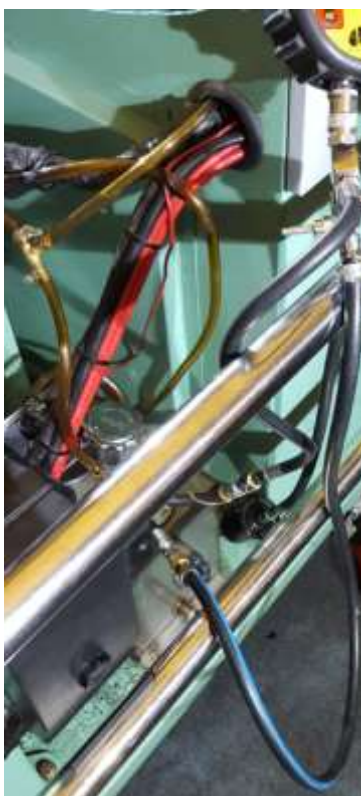
Figura A - 12. Conexión del sistema de combustible para toma de muestra de presión baja de 25 psi. Fuente: Autores.
