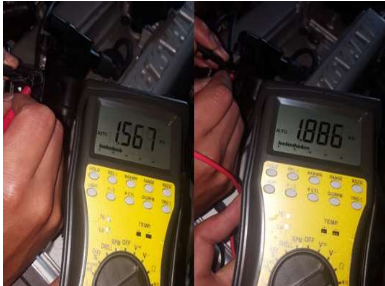
Figura A - 23. Medición de la resistencia del secundario de las bobinas de encendido. Bobinas de encendido no apropiadas para la unidad experimental. Fuente: Autores.
