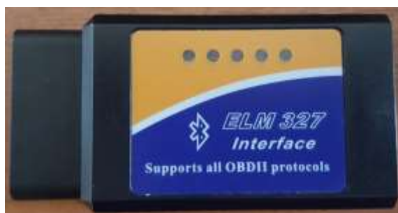
Figura A - 2. Scanner automotriz ELM 327 interface, mediante bluetooth. Fuente: Autores.
