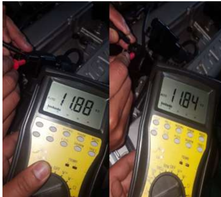
Figura A - 22. Verificación de la resistencia secundaria de las bobinas de encendido de la unidad en estudio. Fuente: Autores.
