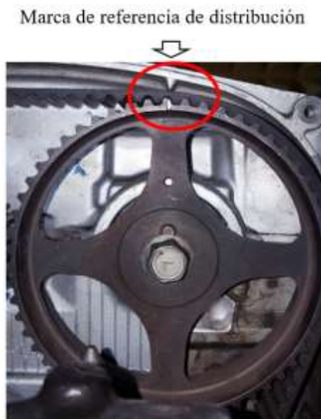
Figura 5.19 Marca de referencia de polea del árbol de levas de escape alineada para el correcto calado. Fuente: Autores.
