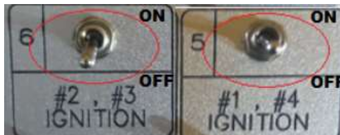
Figura 5.12 Desactivación de bobinas de encendido 1-4 y 2-3. Fuente: Autores.
