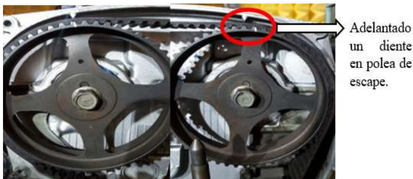
Figura 5.23 Fallo en la polea del árbol de levas de escape al adelantar un diente (+1). Fuente: Autores.
