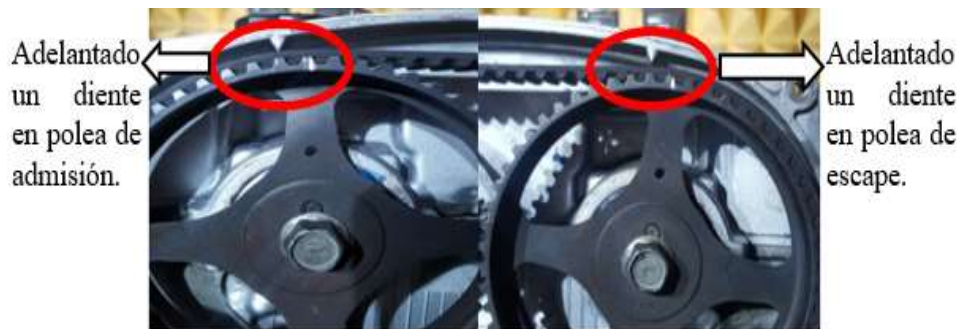
Figura 5.26 Fallo en árbol de admisión (+1) y escape (+1). Fuente: Autores.
