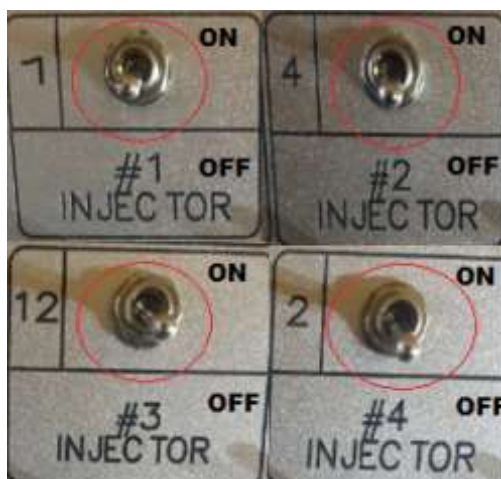
Figura 5.8 Interruptores para cada inyector del motor Sonata 2.0. Fuente: Autores.
