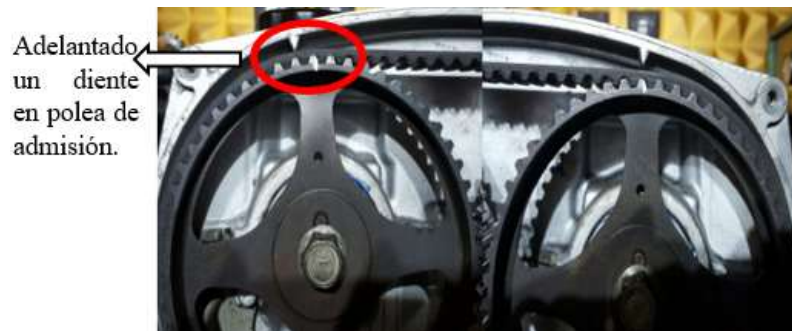
Figura 5.25 Fallo en la polea del árbol de levas de admisión al adelantar un diente (+1). Fuente: Autores.
