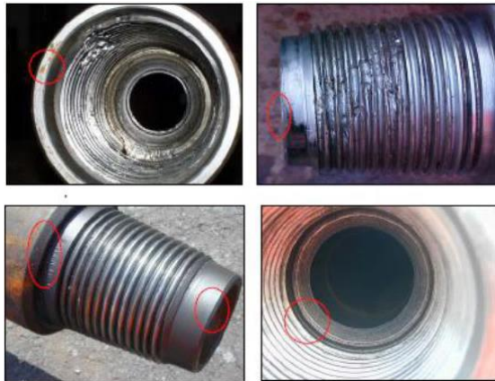
Figura 7. Conexiones dañadas y los sellos dañados causan fallas [17]
