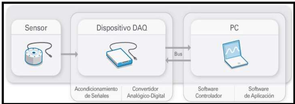
Figura 2.5 Partes de un sistema DAQ
