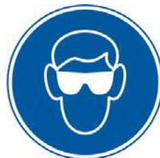
Figura 21. Uso obligatorio de lentes de protección Fuente: (CONRED, 2017)
