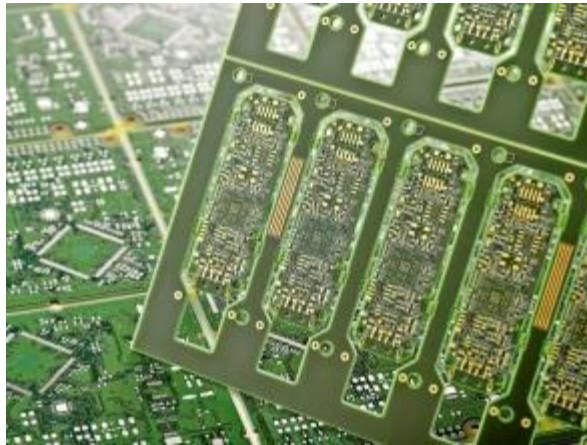
Figura 22 - Circuito impreso multicapa. (Cipsa Circuits ©, 2016)
