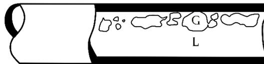
Figura 20 Diagrama de flujo burbujeante [94].
