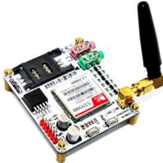
Fig. 5. Módulo SIM900 GPRS/GSM [16]
