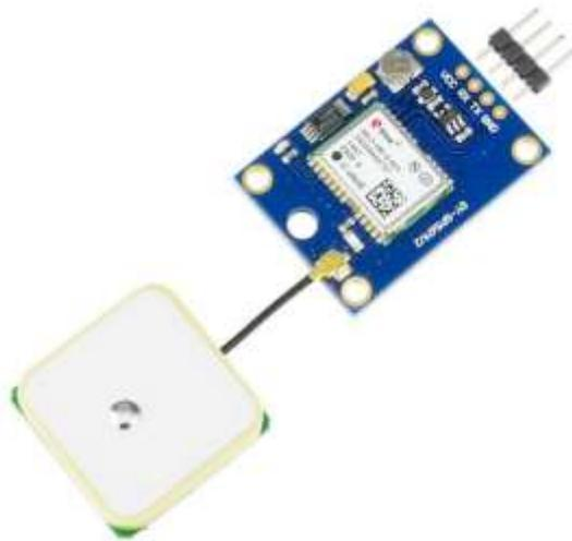
*Fig. 6. Módulo NEO-6M GPS [18]*
