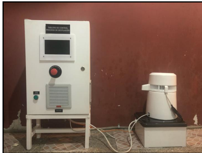
Figura 61. Sistema de calentamiento por inducción
