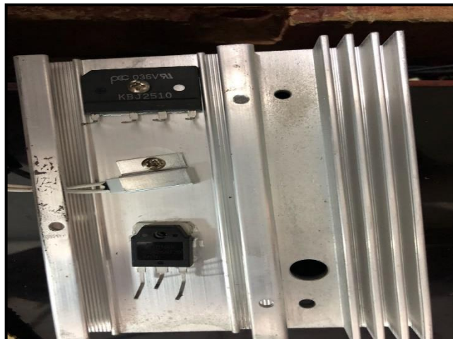
Figura 13. Montaje de elementos de en disipador de calor en placa de potencia.
