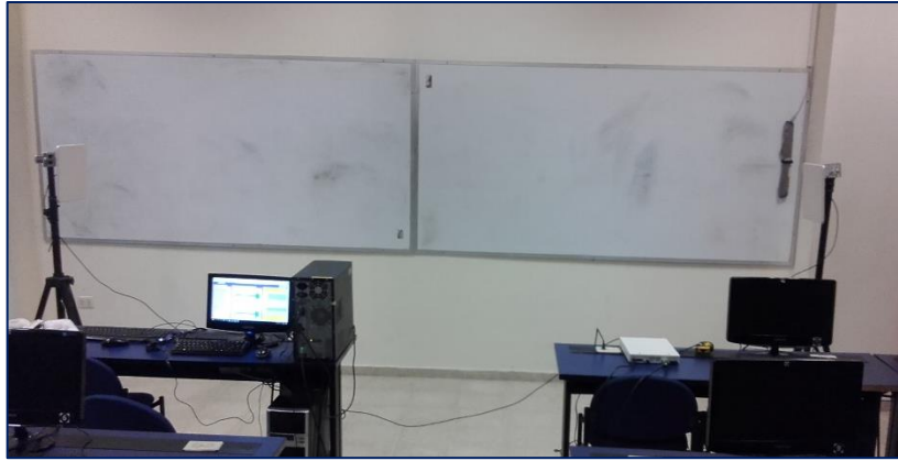
Figura 16. Distancia de 4 metros entre las dos antenas Patch.
