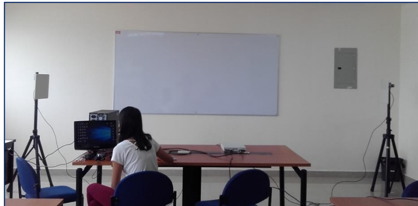
Figura 17. Distancia de 4.5 metros entre las dos antenas Patch.
