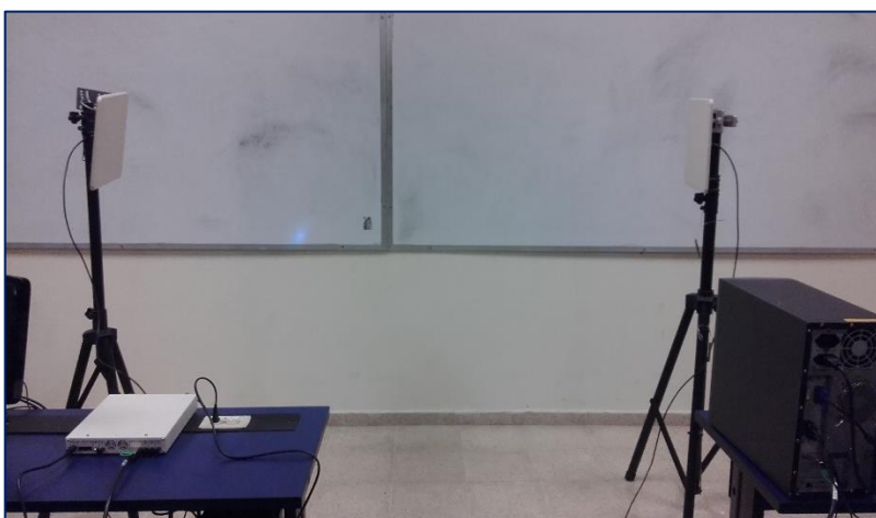
Figura 12. Distancia de 2 metros entre las dos antenas Patch.
