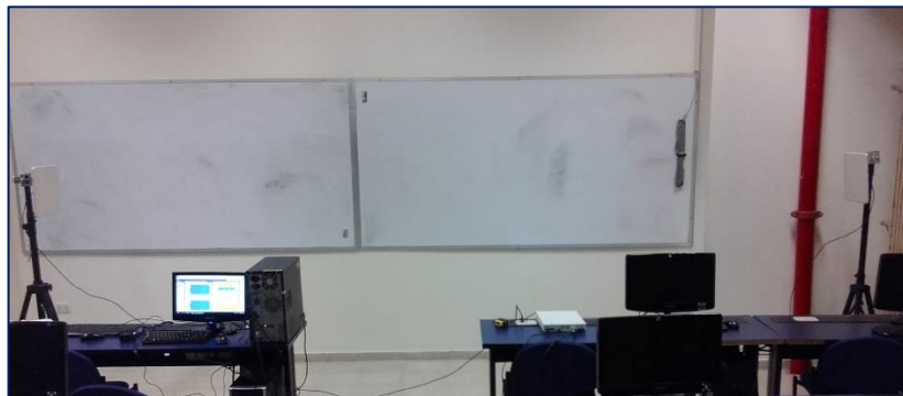
Figura 18. Distancia de 5 metros entre las dos antenas Patch.
