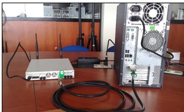
Figura 4.1 Interconexión del USRP RIO 2943 con la PC.
