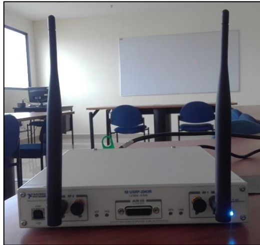
Figura 4.5 Antenas Vert2450 conectadas al USRP RIO.
