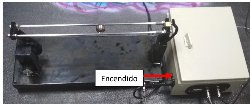
Figura 41 Conexiones entre planta y caja de control
