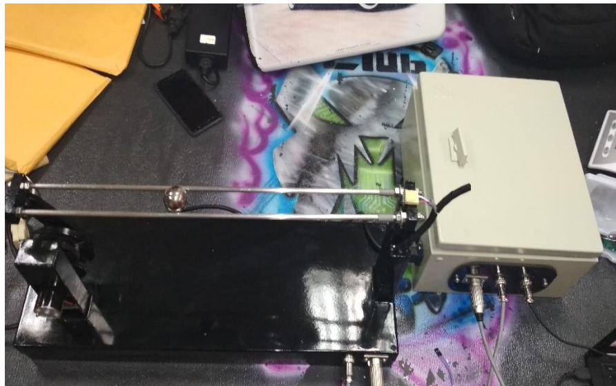
Figura 63 Planta Balón y Viga 2
