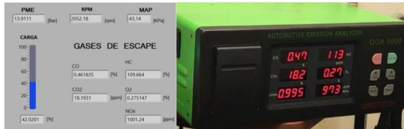
**Figura A 15.** Toma 2 - 2000 Rpm. **Fuente:** Autores.
