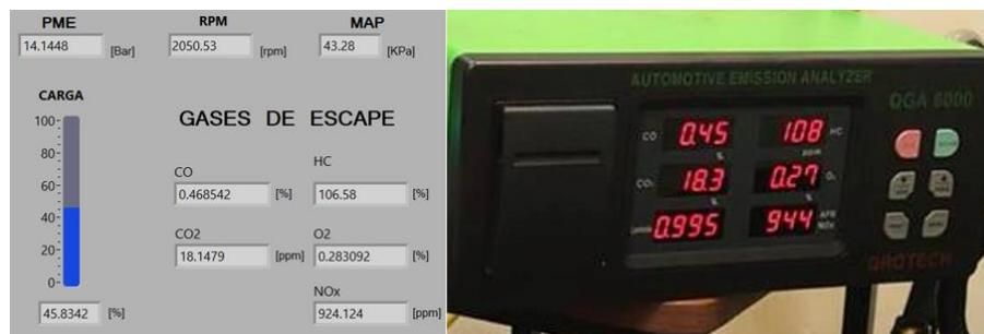
**Figura 54.** Valores simulados vs valores reales de los gases de escape a 2000 rpm. **Fuente:** Autores.
