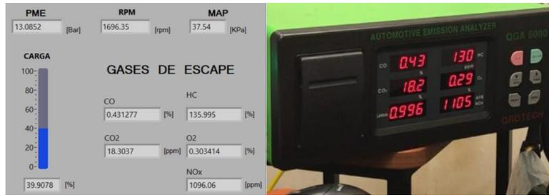
**Figura A 28.** Toma 8 - 1700 Rpm. Fuente: Autores.
