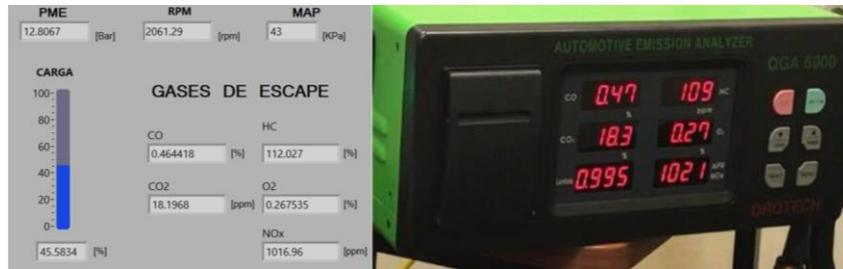
**Figura A 21.** Toma 8 - 2000 Rpm. Fuente: Autores.
