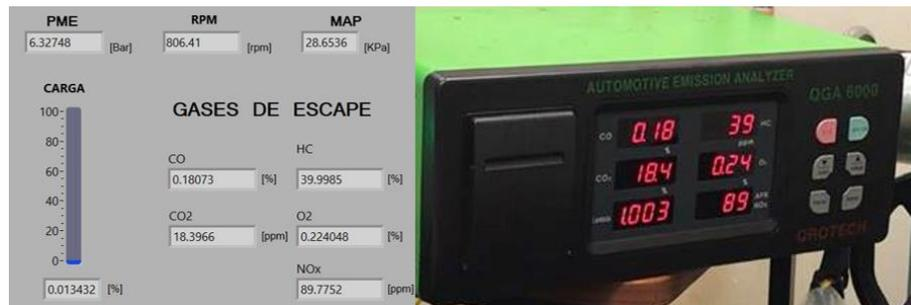
**Figura 53.** Valores simulados vs valores reales de los gases de escape a Ralentí. **Fuente:** Autores.
