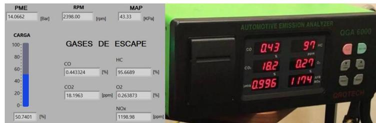
**Figura A 30.** Toma 3 - 2300 Rpm. Fuente: Autores.
