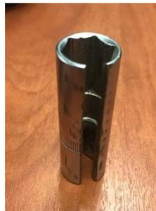
**Figura 19.** Dado de bujías mecanizado. **Fuente:** Autores.
