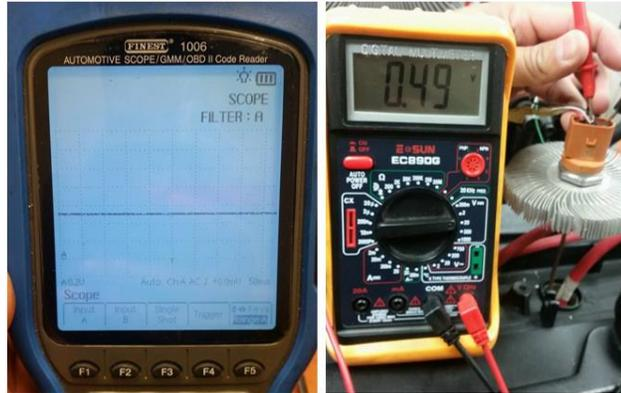
**Figura 23.** Comprobación del voltaje de salida del sensor a presión atmosférica. **Fuente:** Autores.
