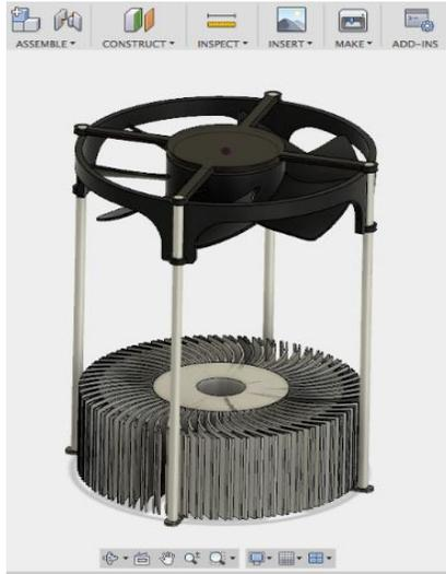
**Figura A 4.** Diseño del disipador de calor. **Fuente:** Autores.
