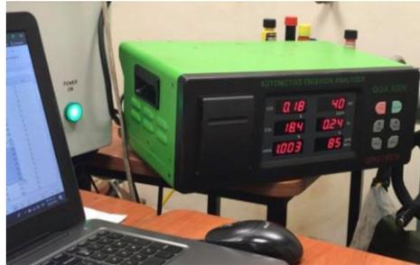
**Figura 13.** Gases de escape iniciales del motor Hyundai Accent. **Fuente:** Autores.
