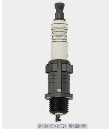
**Figura A 1.** Diseño de la bujía. **Fuente:** Autores.
