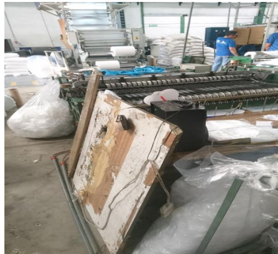
Figura 16.- Selladora obstruida por objeto ajeno al proceso Fuente: Autor
