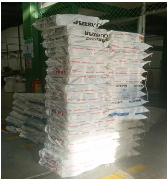
Figura 17.- Mal apilamiento de producto terminado.
