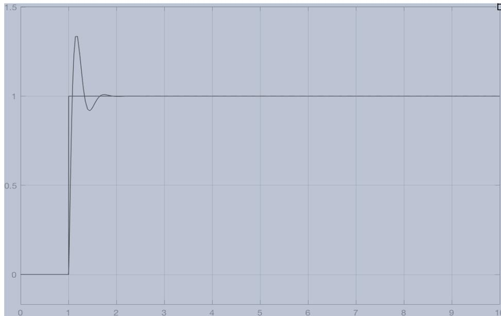
Salida del motor CD controlada por un compensador PID. Elaborado por: Nadim Tito
