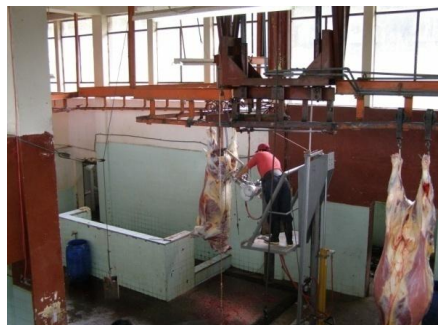
Fig. 20: Corte de canales desde una plataforma.
