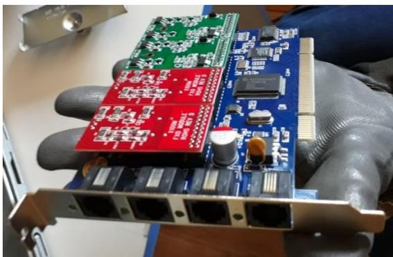
Gateway Digium TDM400P para conexión del servidor Elastix con PSTN. Elaborado por: Alexander Molina
