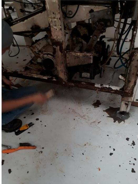
Figura 88. Retiro del Oxido de la estructura Metálica
