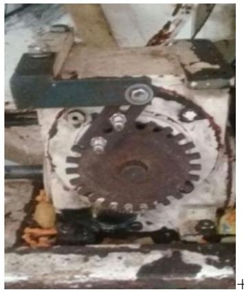
Figura 59. Sistema de posición anterior encoder incremental
