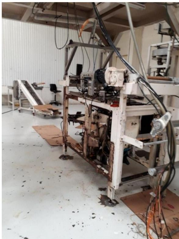
Figura 58. Estado inicial de la maquina empacadora
