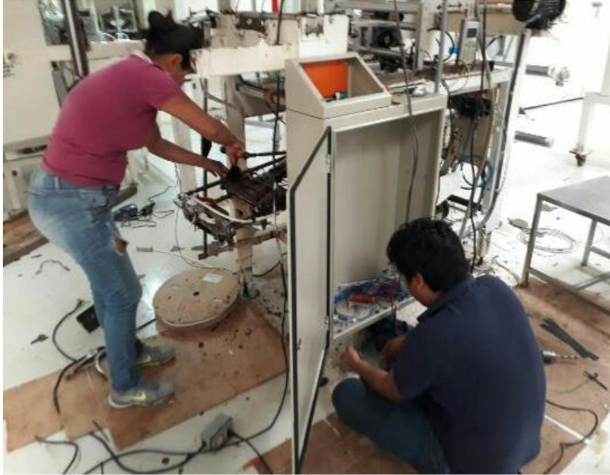
Figura 92. Cambio de mangueras y conectores
