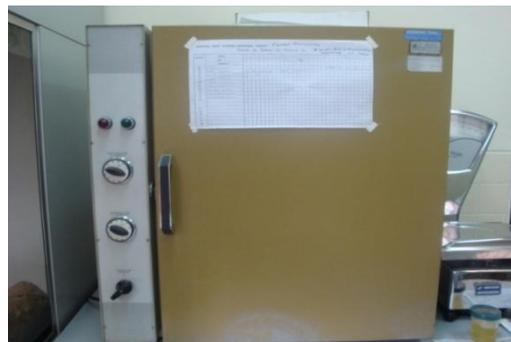
**Figura. 99** Estufa a temperatura ambiente para crecimiento de bacterias
