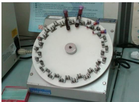
Figura 23. Homogenizador de muestras de sangre
