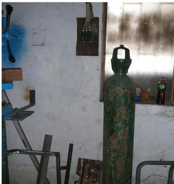
**Fig. 1.61.** *Almacenamiento de materiales inflamables en la sección de soldadura del DMVIML.*
