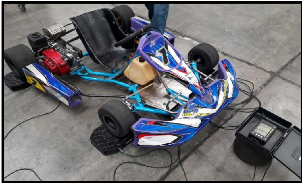
Figura 6.193 Colocación del vehículo en las balanzas
