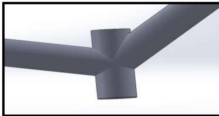
Figura 6.10 Unión de tubos con imperfecciones
