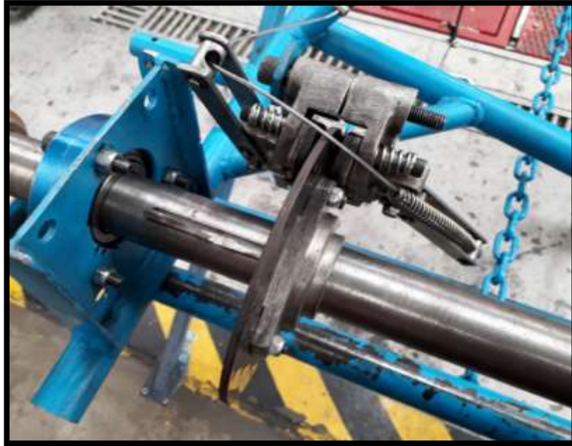
Figura 6.186 Centrado del disco de freno
