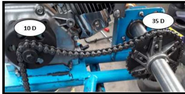
Figura 6.181 Relación de transmisión (Piñón-Corona)
