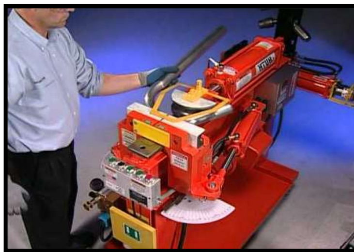
Figura 6.126 Máquina hidráulica de doblado modelo "Huth Benders"
