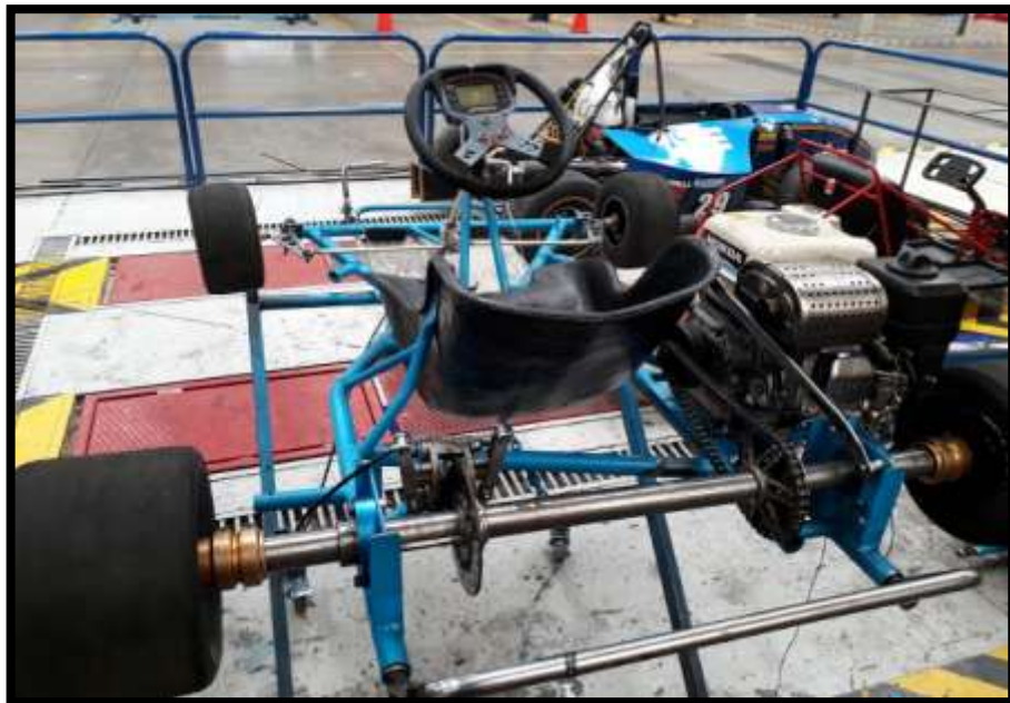
Figura 6.168 Montaje del asiento
