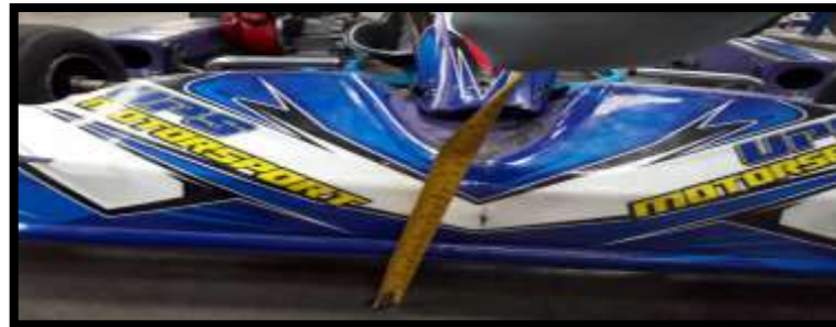
Figura 6.192 Ajuste de la altura del pontón frontal
