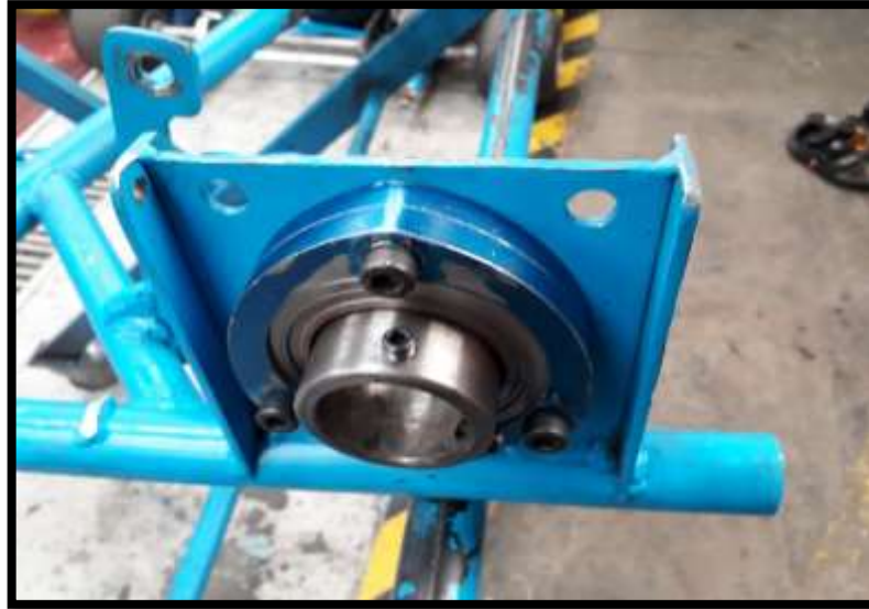
Figura 6.152 Montaje de porta rodamientos al chasis
