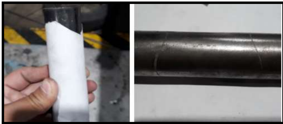
Figura 6.130 (a) Colocación de las plantillas; (b) Marcado de plantillas
