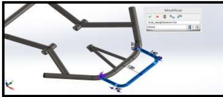
Figura 6.9 Dimensiones de los tubos para el parachoques delantero
