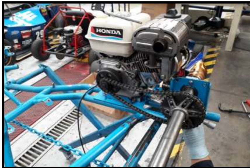
Figura 6.157 Montaje del sistema de transmisión
