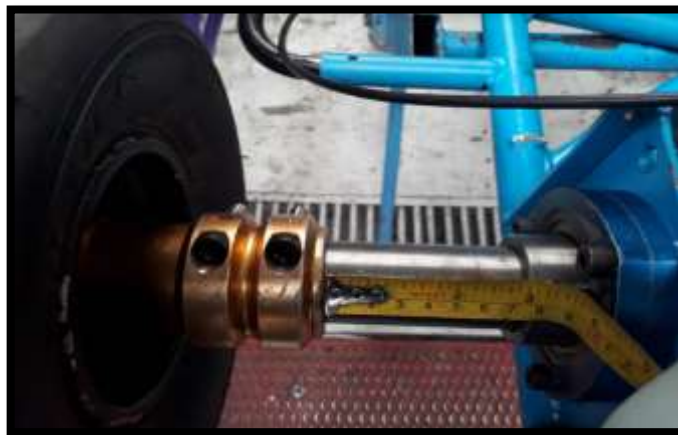
Figura 6.178 Reglaje de la trocha posterior
