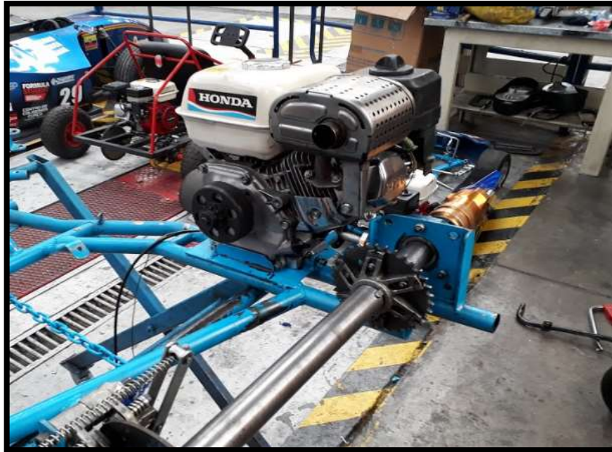
Figura 6.156 Montaje de la unidad de potencia al chasis
