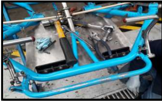
Figura 6.184 Calibración del recorrido de los pedales
