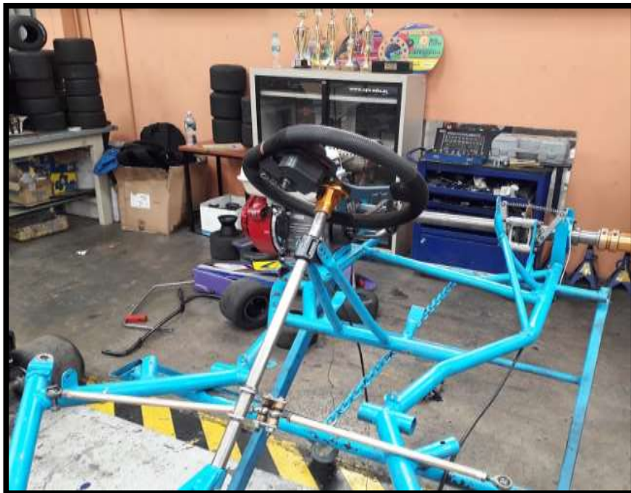
Figura 6.158 Montaje de la columna de dirección
