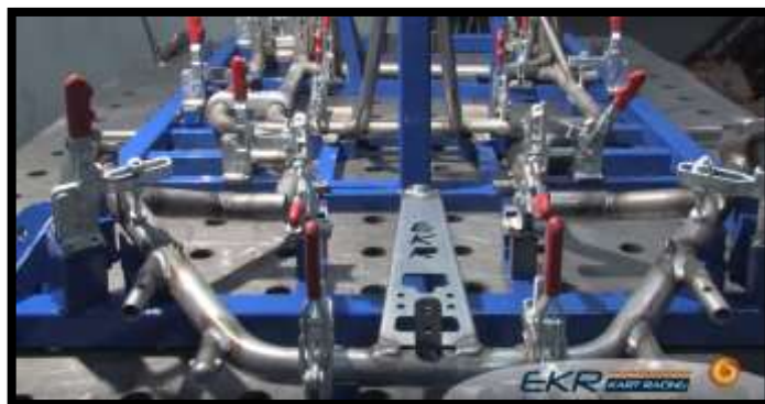
Figura 6.117 Matriz metálica para el armado de un chasis modelo EKR
