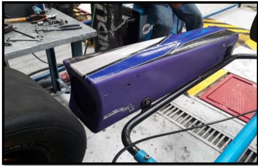
Figura 6.173 Montaje de los pontones laterales
