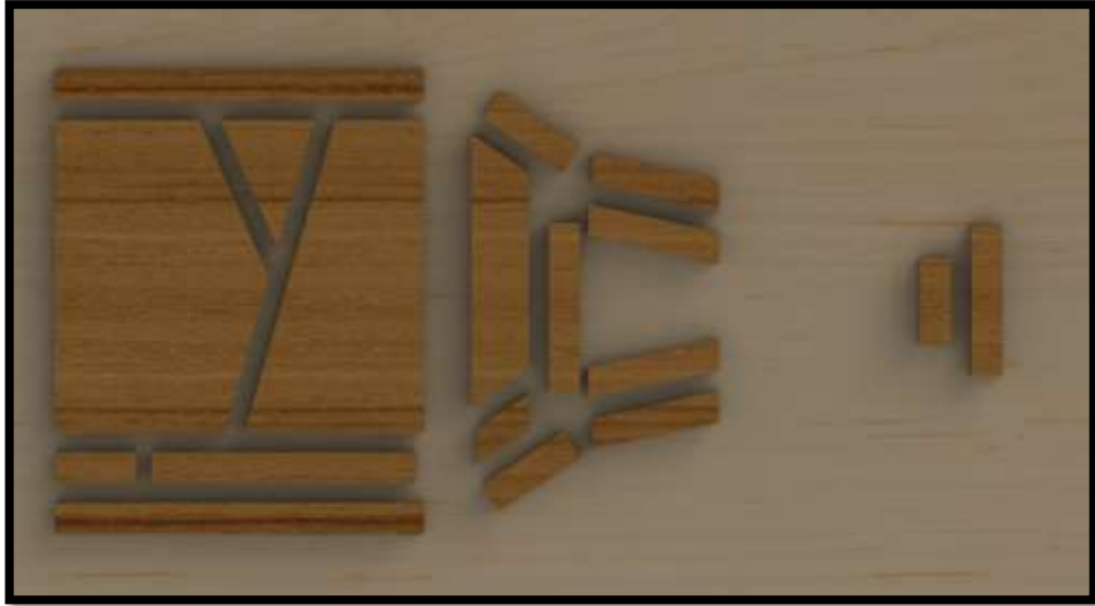
Figura 6.116 Matriz para el armado del chasis
