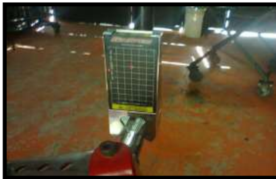
Figura 6.180 Calibración de los ángulos de la dirección mediante laser
