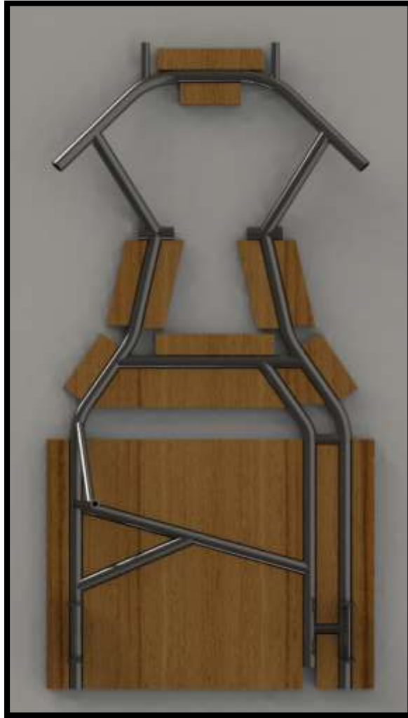
Figura 6.133 Armado del chasis en la matriz
