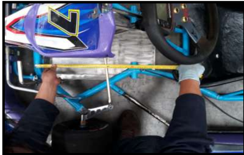
Figura 6.188 Graduación de la distancia frontal izquierda del asiento
