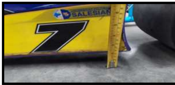
Figura 6.191 Ajuste de la altura de los pontones laterales
