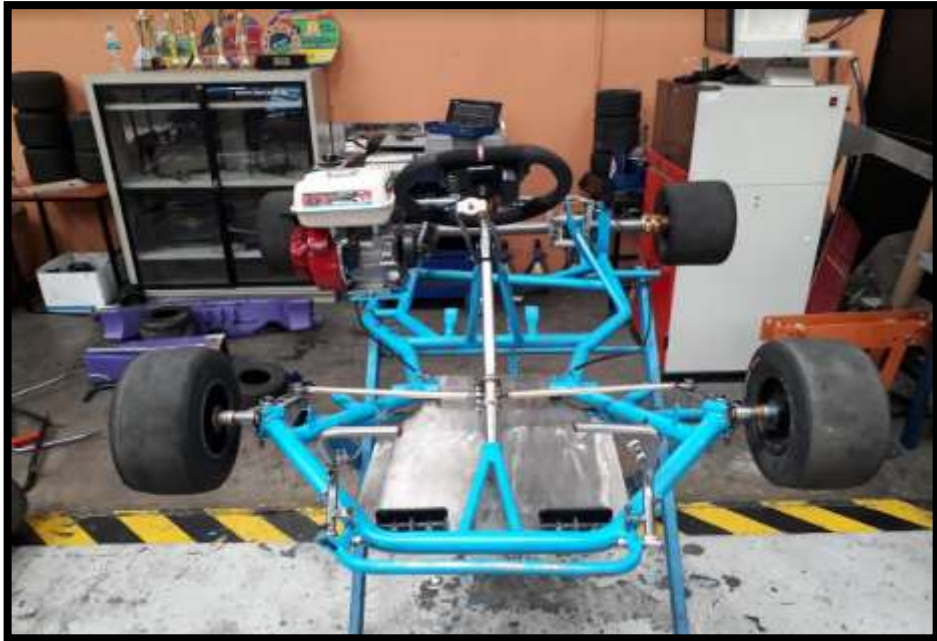
Figura 6.167 Montaje de los neumáticos delanteros
