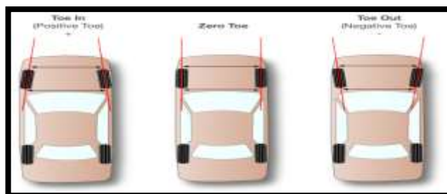
Figura 5.18 Convergencia y divergencia
