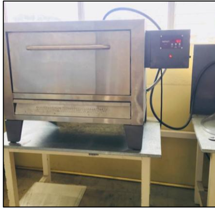
Imagen 2. 5: Horno para el curado de la fibra de carbono
