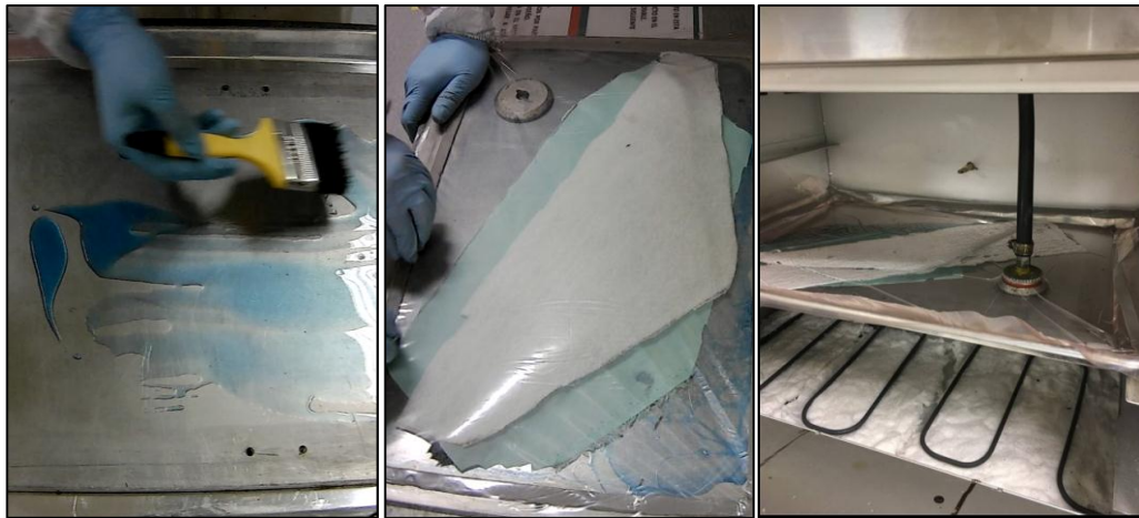
Imagen 3. 5: Proceso de vaciado de la pieza antes del curado.
