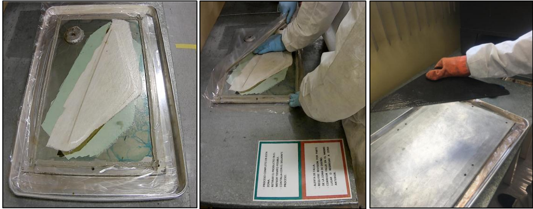
Imagen 3. 7: Proceso de desenfundado de la pieza
