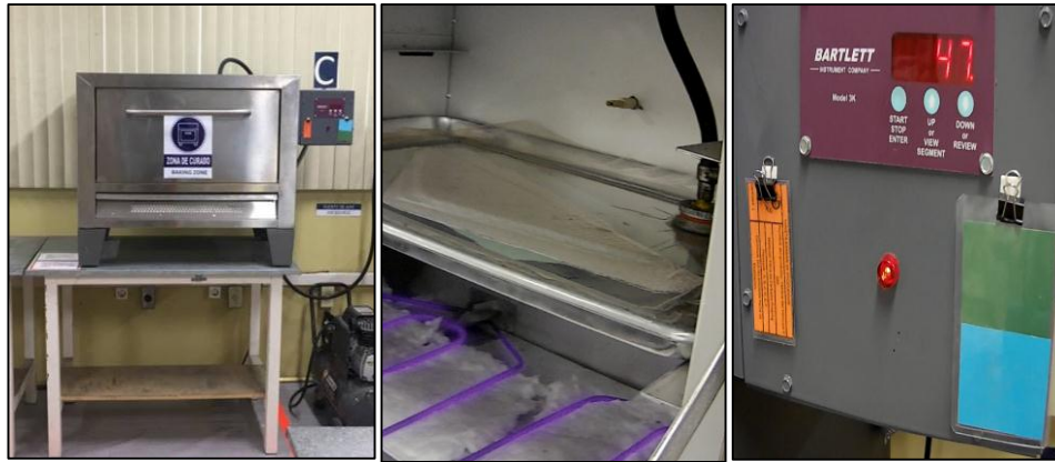
Imagen 3. 6: Zona de curado (C), temperatura a 150, tiempo 1h40.
