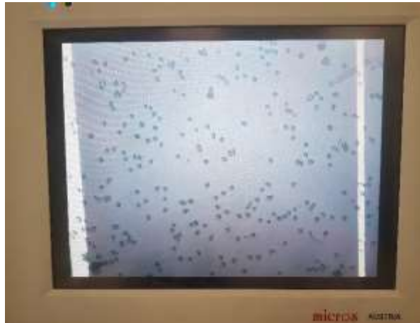
Figura 11: Esporas de Trichoderma sp., en un cuadrante de la cámara de Neubauer, bajo el lente 40X del microscopio de pantalla Micros AUSTRIA.
