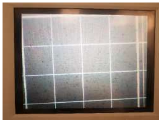
Figura 10: Esporas de Trichoderma sp., en una sección de los cuadrantes de la cámara de Neubauer, bajo el lente 40X del microscopio de pantalla Micros AUSTRIA.
