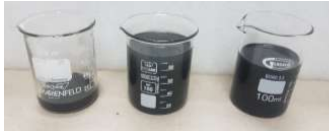
Figura 15: Contaminante diluido en aceite de vaselina en 3 concentraciones de izquierda a derecha; 1 en 10, 1 en 100 y puro.
