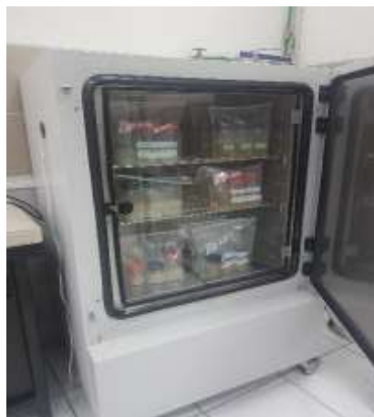
Figura 17: Frascos etiquetados, colocados en fundas herméticas y almacenados en estufa BINDER.
