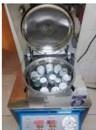
Figura 13: Frascos con medio de cultivo líquido de papa al interior del autoclave para ser esterilizados a 121 °C durante 20 min.
