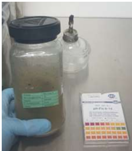
Figura 20: Medición de pH con tiras comerciales durante el proceso de biodegradación.
