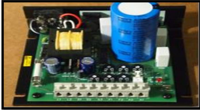
FIGURA. 47. TARJETA ELECTRÓNICA VARIADORA DE VELOCIDAD
