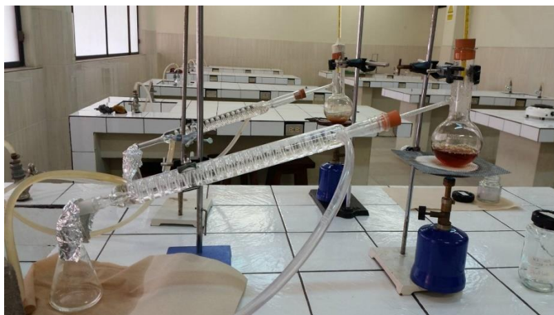
Figura 34. Destilación Simple de las muestras para la obtención de bioetanol
