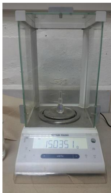
Figura 35. Medición de la densidad de las muestras por medio del picnómetro
