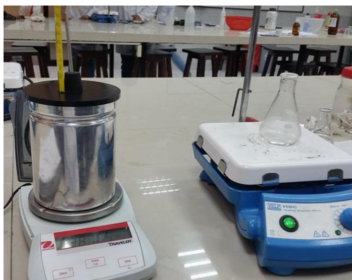
Figura 36. Peso del calorímetro vacío (izquierda) y calentamiento de la muestra a analizar (derecha).
