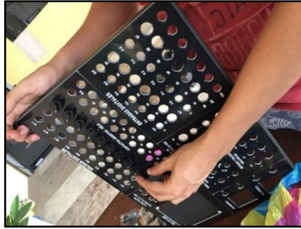
FIGURA 31: COLOCACIÓN DE LA LÁMINA ABS Y LA TAPA METÁLICA MOVIL [AUTORES]
