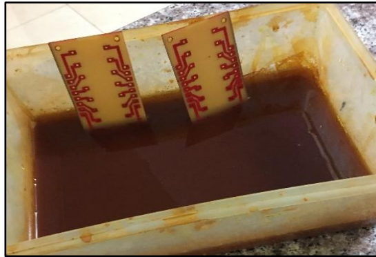
FIGURA 46: BAQUELITAS SUMERGIDAS EN PERCLORURO DE SODIO [AUTORES]
