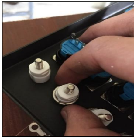
FIGURA 35: COLOCACIÓN DE JACKS BANANA [AUTORES]
