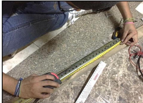
FIGURA 41: MEDICIÓN DE LAS DIFERENTES MEDIDAS DE LA RIEL DIN [AUTORES]
