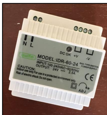
FIGURA 19: FUENTE VARIABLE IDR-60-24 VDC [AUTORES]
