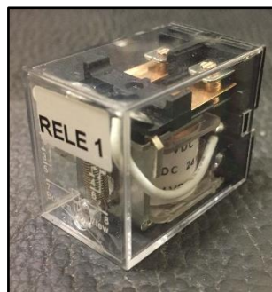
FIGURA 21: BOBINA DE RELÉ LY2 DE 24 VDC [AUTORES]
