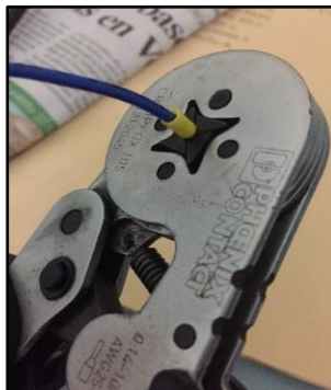
FIGURA 50: PINZA PONCHADORA DE PUNTERAS PARA TERMINALES TIPO TUBULAR [AUTORES]
