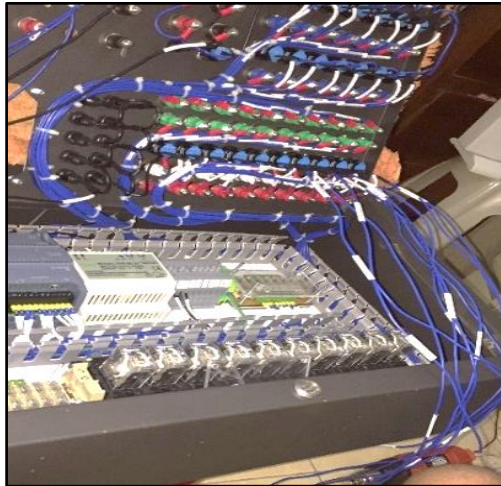
FIGURA 54 : CABLEADO DE LA TAPA MÓVIL HACIA LA PARTE INTERNA DEL MALETÍN [AUTORES]
