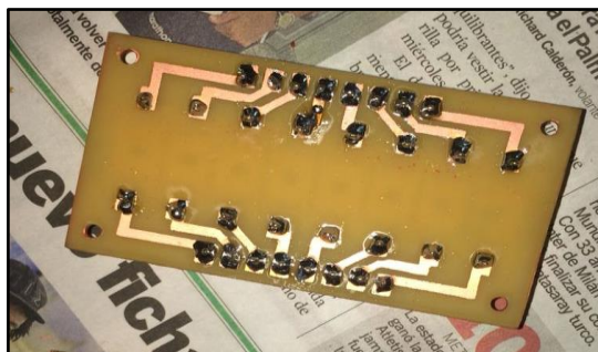
FIGURA 48: PROCESO DE SOLDAR LOS ELEMENTOS EN LA BAQUELITA [AUTORES]
