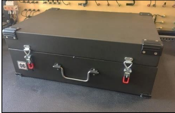
FIGURA 60: COLOCACIÓN DE ABRAZADERAS Y AGARRADERAS DEL MALETÍN [AUTORES]
