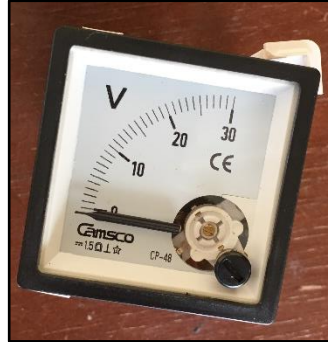
FIGURA 20: VOLTÍMETRO ANALÓGICO CP-48 DE 30 VDC [AUTORES]
