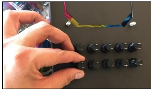
FIGURA 32: COLOCACIÓN DE LUCES PILOTO [AUTORES]
