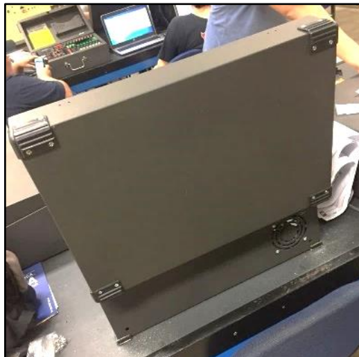
FIGURA 61: COLOCACIÓN DE ESQUINEROS PLASTICOS [AUTORES]
