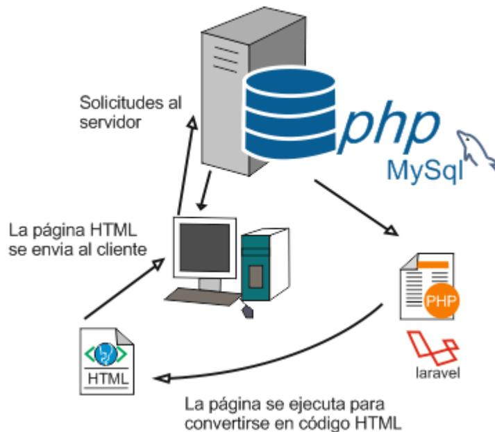
Ilustración 1 - Esquema del Funcionamiento de las páginas Web
