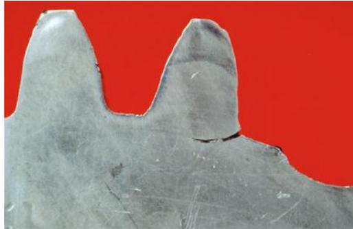
Figura 28. Grieta en la raíz de un diente de engrane [84].
