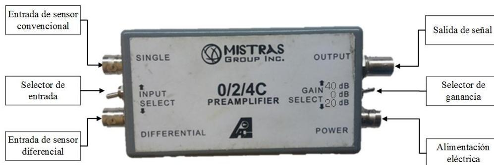
Figura 13. Preamplificador 0/2/4C.
