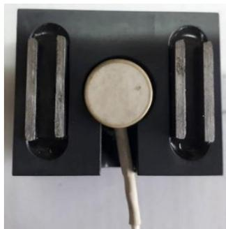
Figura 53. Sensor WD S/N FV52 en un soporte magnético MHSTD.
