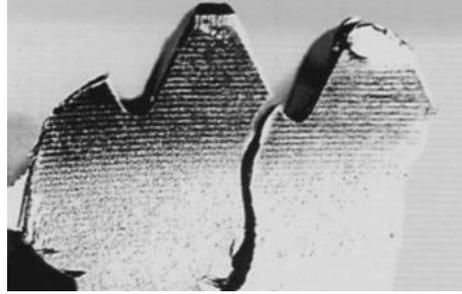
Figura 32. Grietas de la llanta y disco [81].
