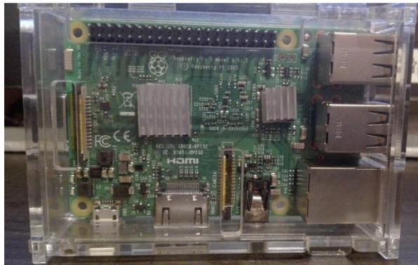
Tarjeta Raspberry Pi 3 Model B utilizada en la implementación del proyecto, Adrián López & Diego Zapata
