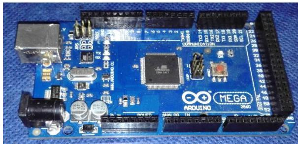
Tarjeta Arduino Mega 2560 Utilizada en la implementación del proyecto, Adrián López & Diego Zapata
