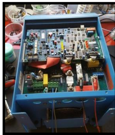
Figura 78: Componentes electrónicos de un inversor de carga.
