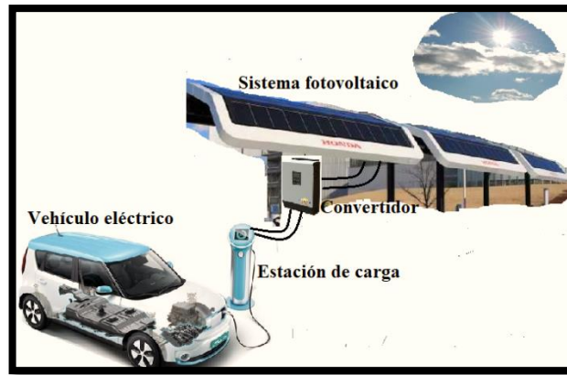
Figura 45: Carga del vehículo eléctrico utilizando el sistema fotovoltaico.
